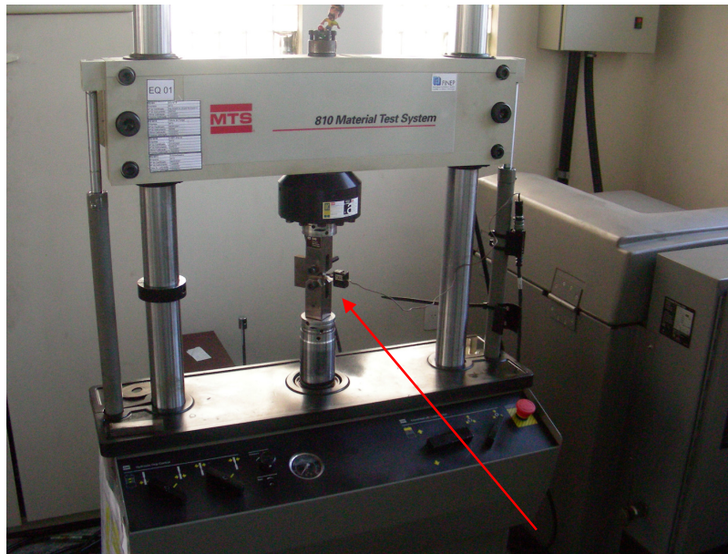
Figura 17: Máquina universal de ensaio de fadiga com dispositivo de fixação de ensaio em detalhe.
