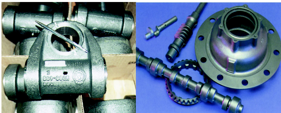
Figura 2: Componentes fabricados em ADI de aplicações automotivas [John R. Keough and Kathy L. Hayrynen- Propriedades do ferro fundido nodular austemperado 2002].
