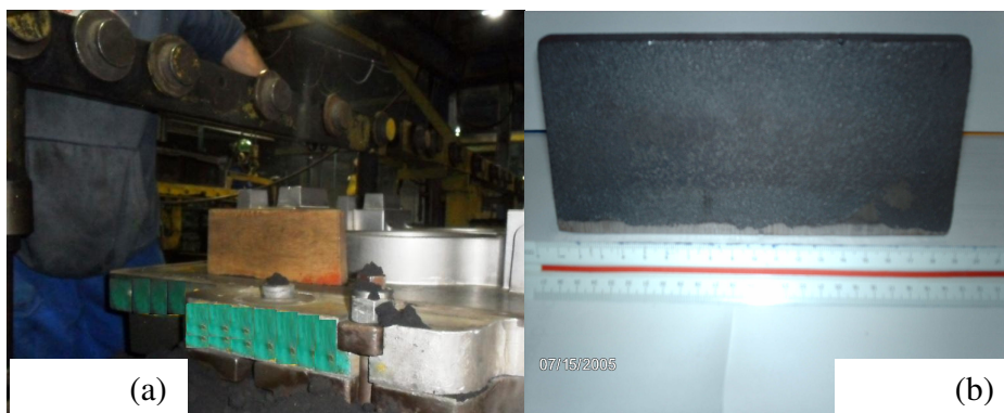
Figura 14: Moldagem do bloco para fusão da liga e bloco fundido em nodular 65-45-12.
