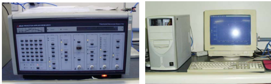
Figura 3.1 Potenciostato e computador utilizado para a obtenção dos dados.
