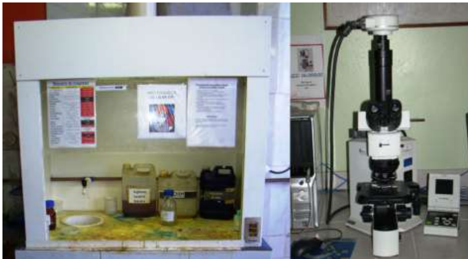
Figura 31 - Esquerda: Capela para manipulação de reagentes químicos; Direita: Microscópio Ótico Olympus BX51M.
