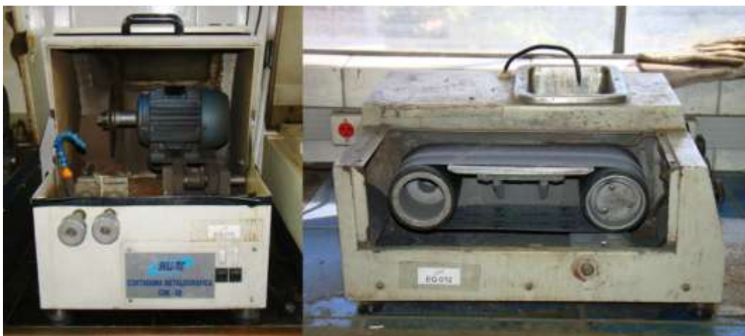
Figura 29 - Esquerda: cortadeira metalográfica Skill-Tec CSK 80; Direita: Cinta Lixa (Opera com lixa granulométrica 80)
