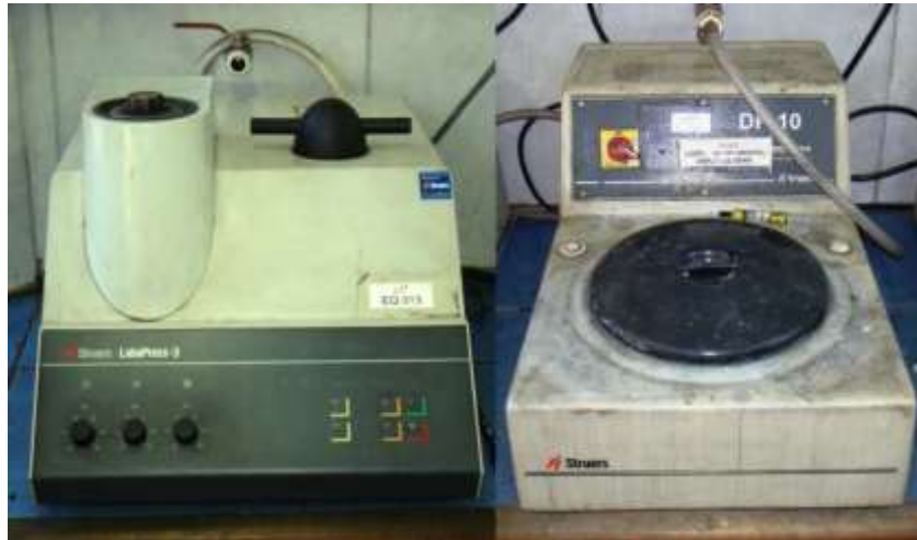
Figura 30 - Esquerda: Embutidora Metalográfica Struers Labpress 3; Direita: Politriz Struers DP-10.
