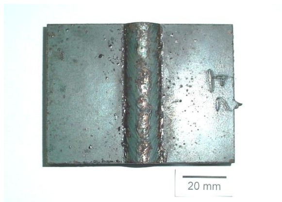
Figura 3.5 Corpo de prova para análise metalográfica retirada da chapa soldada.
