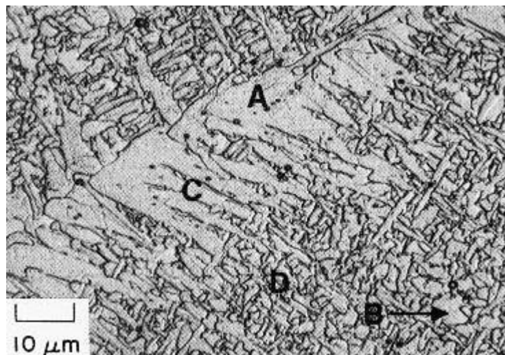
Figura 2.8 Micrografia típica de um metal de solda de um aço baixo carbono. Morfologias da ferrita: A, alotriomorfa; B, idiomorfa; C, Widmanstätten; D, acicular (KOU 2003).
