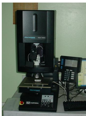
Figura 3.16 Perfilômetro Instron Tukon 2100 B usado para realizar perfis de microdureza.
