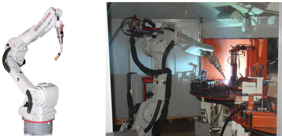
Figura 3.1 Robô Motoman's EA1900N utilizado para a realização dos cordões de solda dos corpos de prova.
