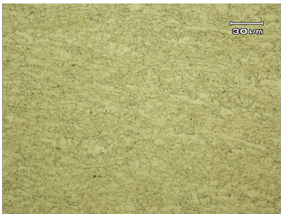
Figura 4.4 Microestrutura do MB do corpo de prova C2.
