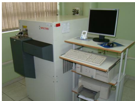
Figura 3.17 Espectrômetro de emissão ótica SpectroLab onde foram realizadas as análises químicas.
