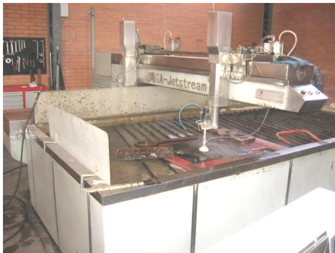
Figura 3.4 Equipamento de corte a base d'água usado para corte dos corpos de prova.
