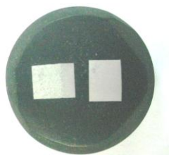
Figura 3.9 Peças de seção longitudinal e do material base embutidas a quente.
