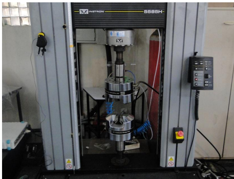
Figura 3.19 Máquina eletromecânica Instron 5585H usada para ensaio de tração.
