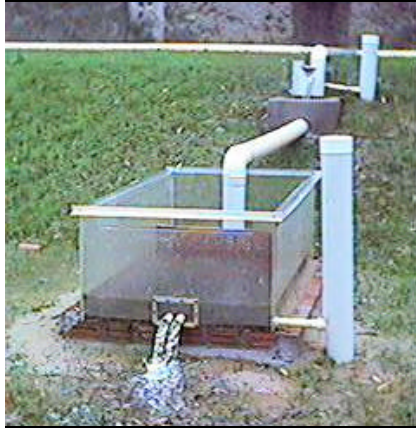
Figura 2.5 – Microrreservatório de detenção no lote, simulado por Cruz et al. (1998) e Agra (2001)
