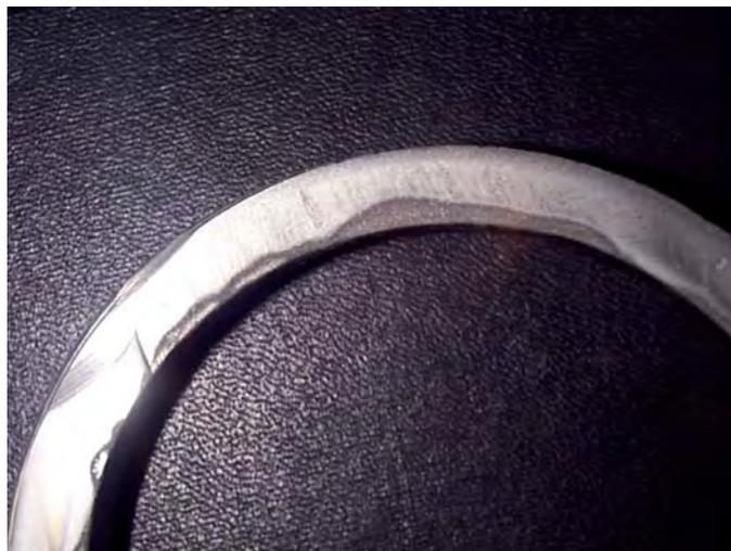
**Figura 103- Delineação da área carburizada da amostra HP40X ensaiada após a indução de um campo magnético**
