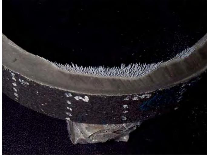
**Figura 100- Delineação da área carburizada da amostra HP40 usada 20.000 horas após a indução de um campo magnético**
