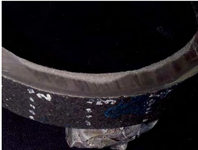
**Figura 102- Delineação da área carburizada da amostra HP40 ensaiada após a indução de um campo magnético**
