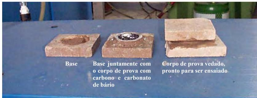
**Figura 23- Corpo de prova sendo preparado para os testes de carburização.**
