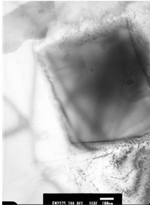
Figura 92- Precipitado coerente, oriundo do processo de fabricação da liga
