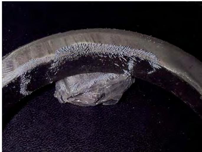
**Figura 101- Delineação da área carburizada da amostra HP40 usada 37.000 horas após a indução de um campo magnético**
