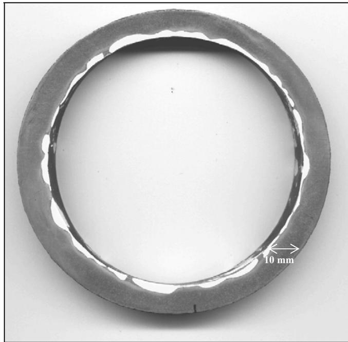
**Figura 24- Camada carburizada após ataque químico**
