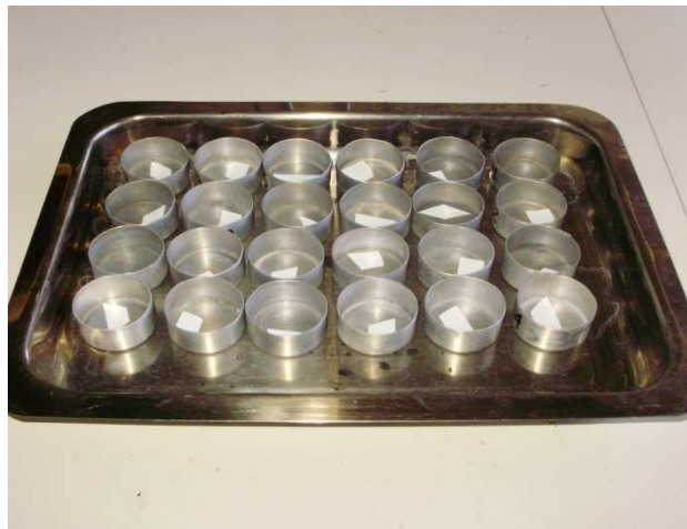
Figura 3.6: Cápsulas com papéis filtro prontas pra serem levadas à estufa.
