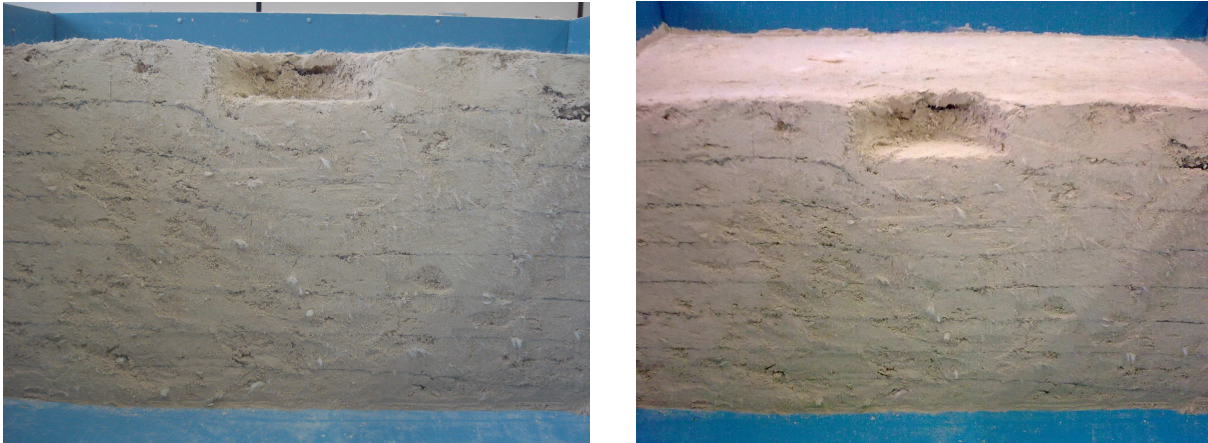
Figura 4.31: Exumação das camadas do ensaio em areia e fibras com D_r = 90\% , (a) vista frontal e (b) vista de cima.
