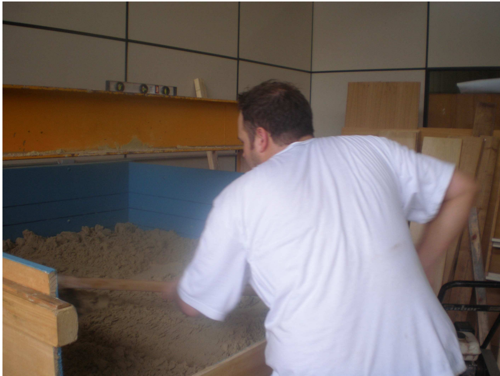
Figura 3.12: Espalhamento do material dentro da caixa.
