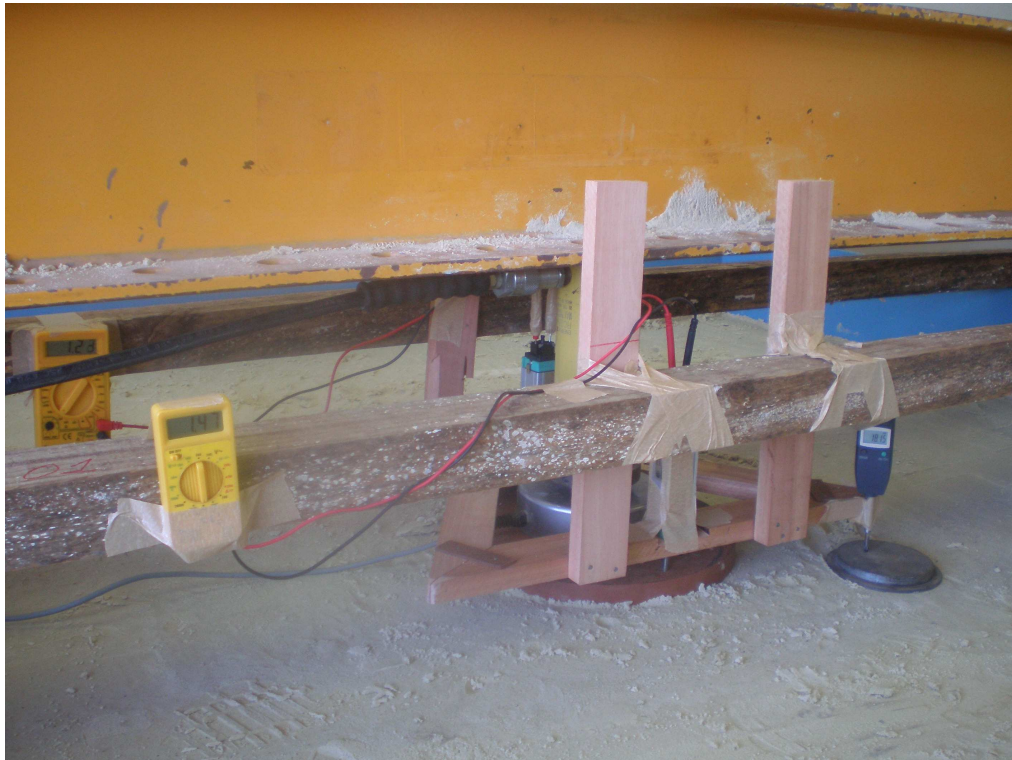
Figura 3.15: Voltímetros digitais conectados às régua resistivas.
