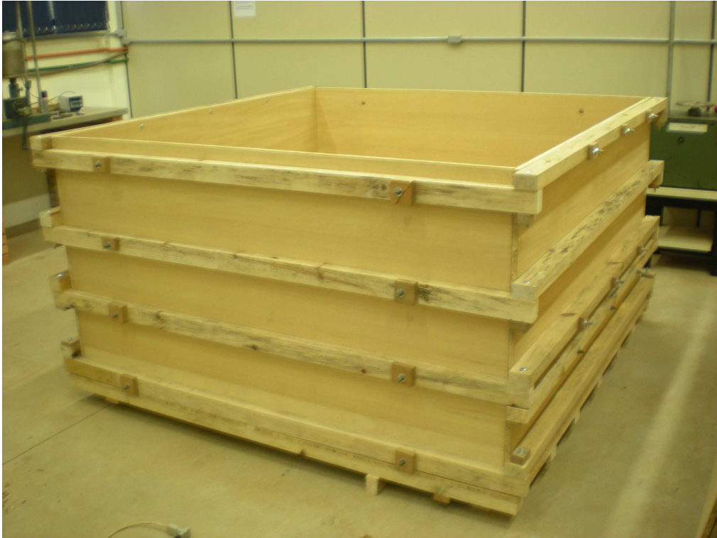
Figura 3.8: Caixa de madeira construída para o ensaio.
