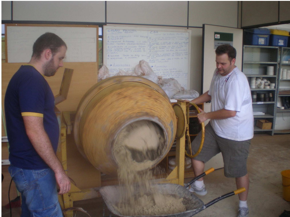
Figura 3.10: Betoneira utilizada para mistura do material.
