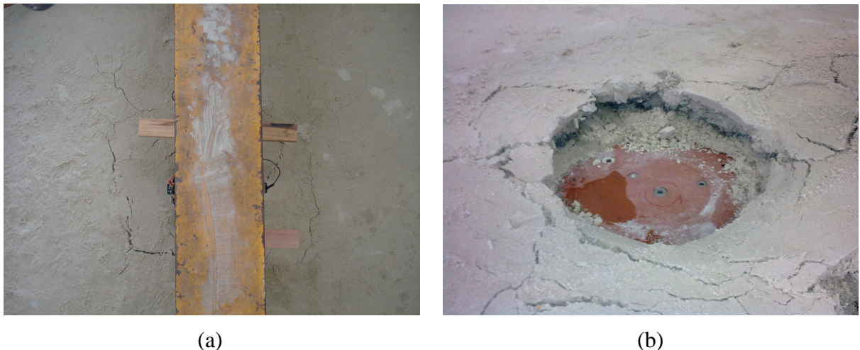
Figura 4.24: Mecanismo de ruptura obtido para camadas de areia com fibras – D_r = 90\% : (a) vista superior e (b) vista lateral
