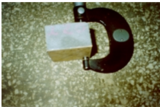
Figura 4.11 Corpo-de-prova submetido ao desgaste por abrasão.
