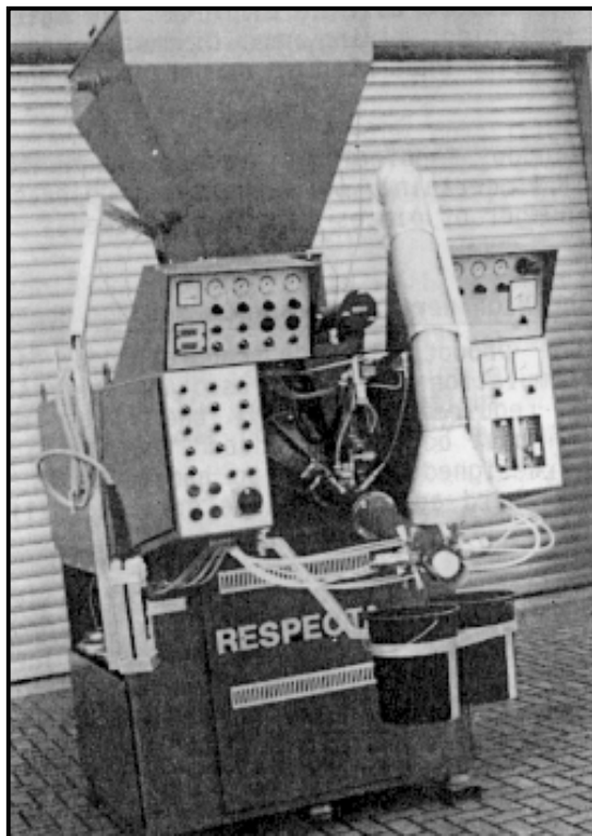
Figura 2.4 Misturador contínuo equipado para 02 tipos de fíler, resina, iniciador, acelerador e exaustor (KREIS 1991 )
