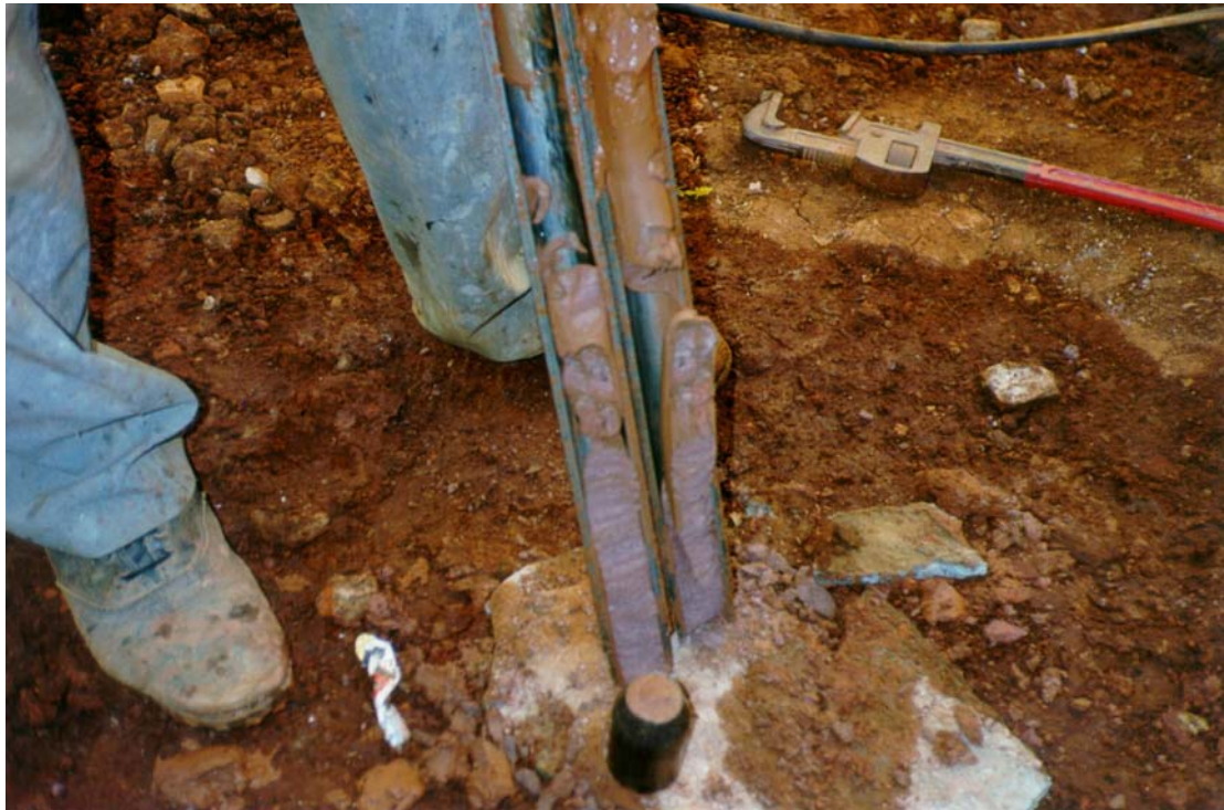
Figura 2.5 – Amostrador padrão bipartido do ensaio SPT.
