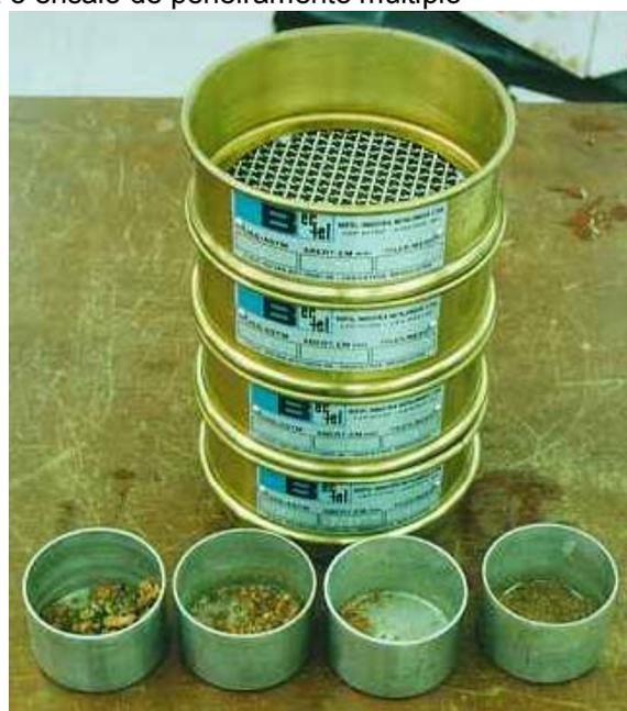
Foto 23 – Estabilidade de agregados – avaliação da distribuição granulométrica dos agregados após ensaio
