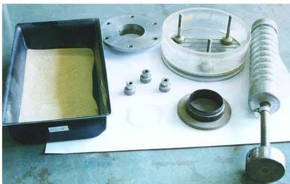
Foto 11 – Ensaio de expansibilidade LNEC – material para preparação da amostra
