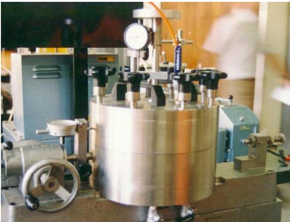
Foto 2 – Equipamento de cisalhamento direto com controle de sucção (CDCS) do LMS/UFRGS – câmara de cisalhamento
