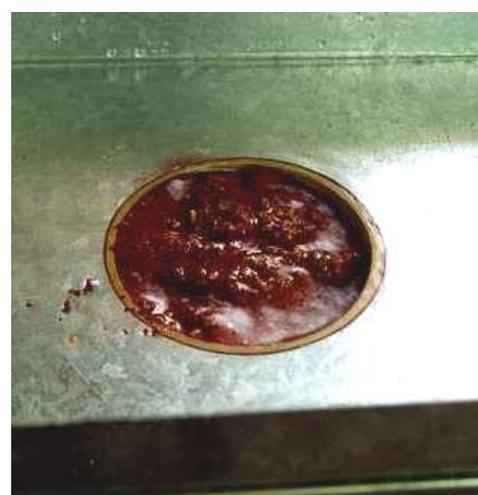
Foto 6 – Ensaio de Inderbitzen – detalhe da amostra erodida pelo fluxo hidráulico
