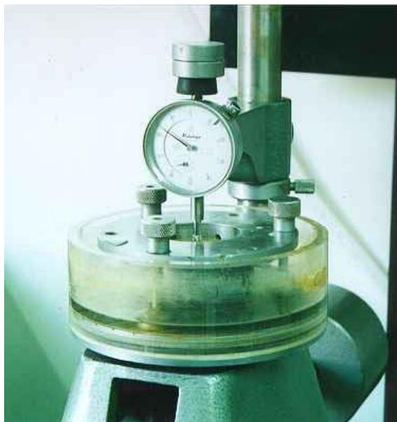
Foto 14 – Ensaio de expansibilidade LNEC – execução do ensaio de expansibilidade
