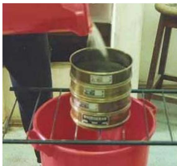
Foto 7 – Ensaio de Inderbitzen – peneiramento do sedimento coletado no ensaio
