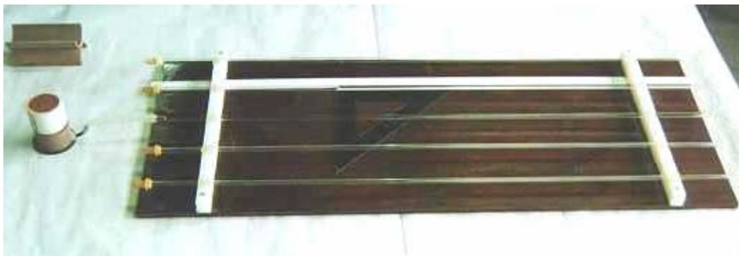
Foto 8 – Metodologia MCT – dispositivo para o ensaio de infiltrabilidade
