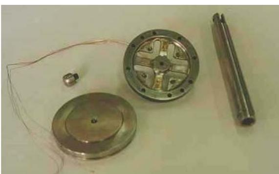
Foto 2 – CDCS – célula de carga interna em montagem
