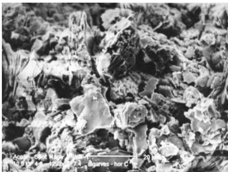
Foto 2 – Imagem em microscopia eletrônica do solo ALGC – aumento de 1292x
