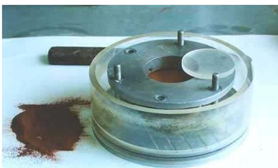
Foto 12 – Ensaio de expansibilidade LNEC – preparação da amostra
