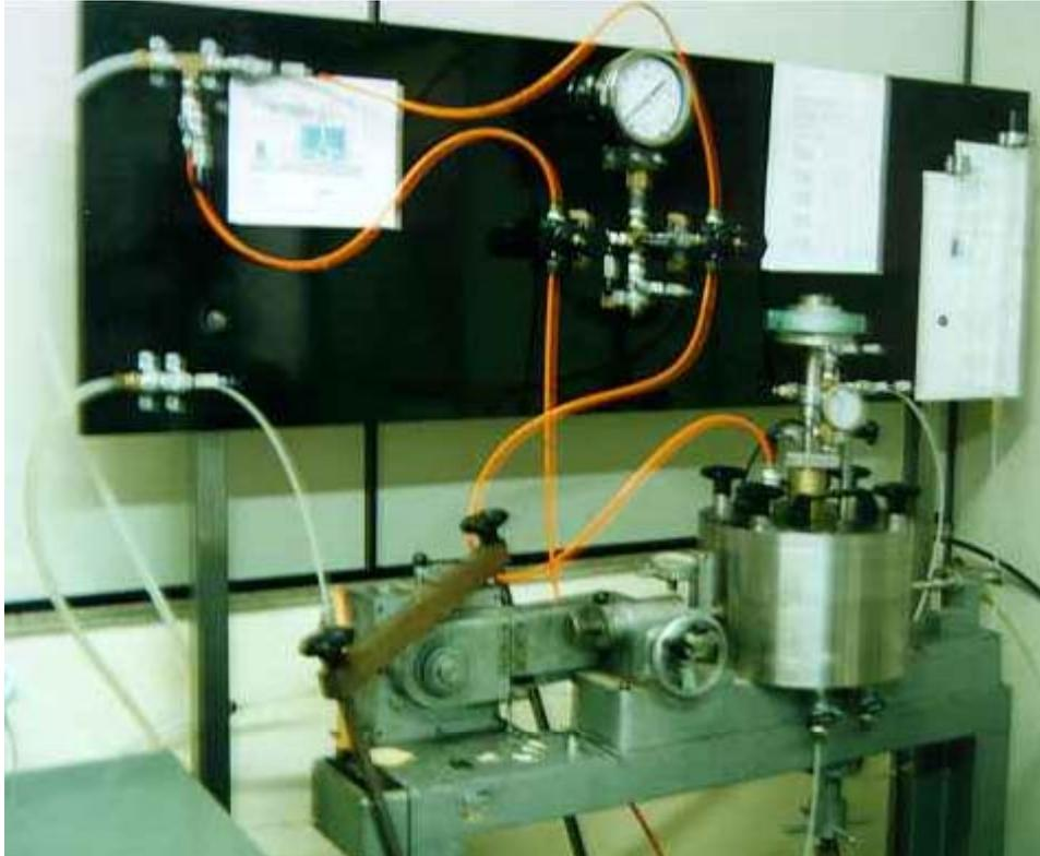
Foto 1 – Equipamento de cisalhamento direto com controle de sucção (CDCS) do LMS/UFRGS – vista geral
