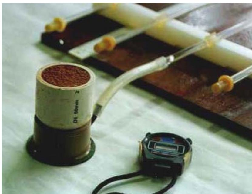
Foto 9 – Metodologia MCT – amostra no ensaio de infiltrabilidade
