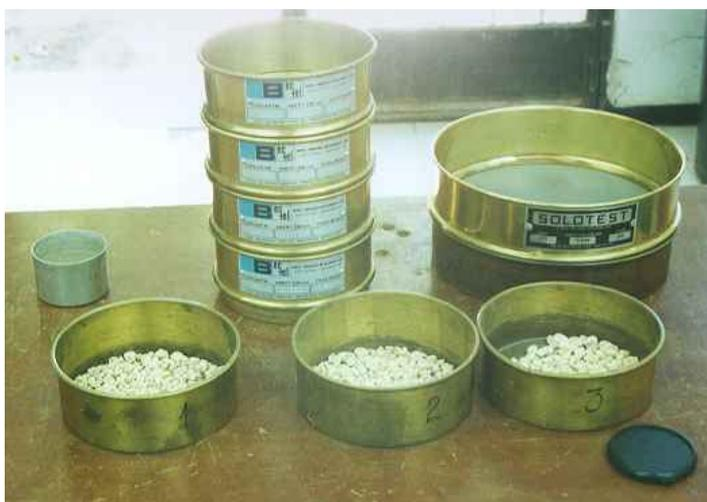
Foto 21 – Estabilidade de agregados – amostras para o ensaio de peneiramento múltiplo
