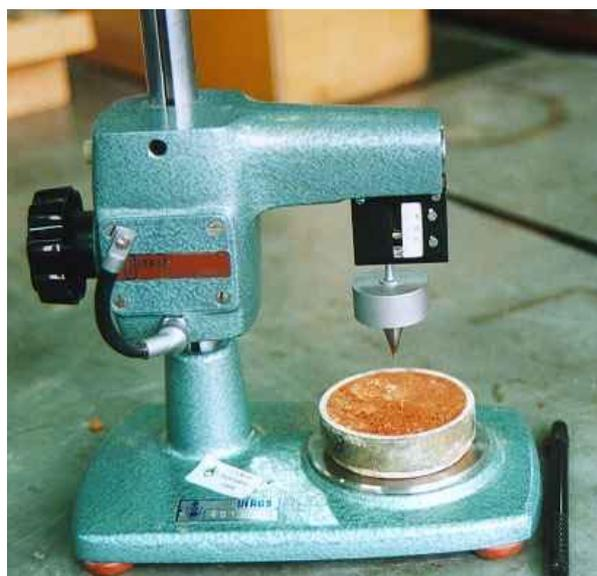
Foto 19 – Ensaio de cone de laboratório em amostra de solo estudado
