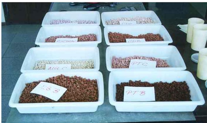
Foto 20 – Solos estudados preparados para análise da estabilidade dos agregados
