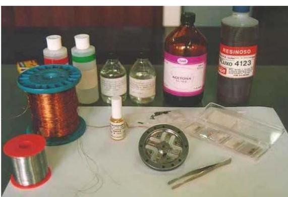
Foto 3 – CDCS – detalhe da colagem de strain gauges na construção da célula de carga
