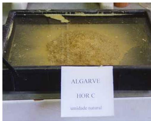
Foto 18 – Ensaio de desagregação – amostra completamente desagregada
