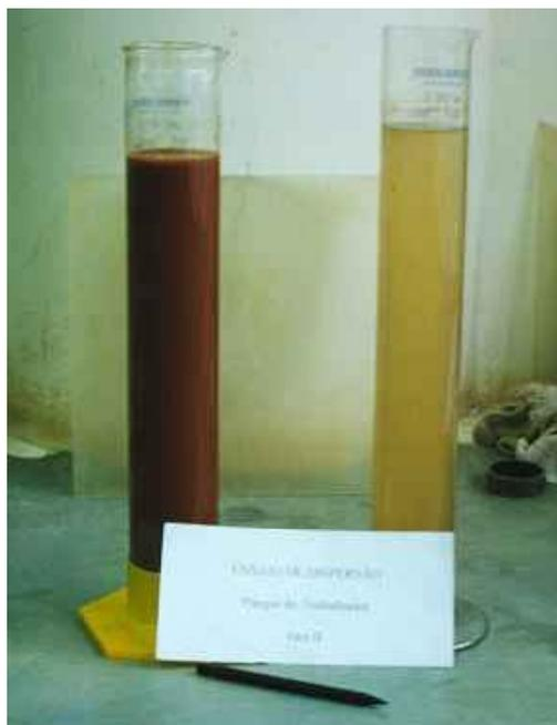
Foto 16 – Ensaio de dispersão SCS – comparação entre ensaios com e sem dispersão química e agitação mecânica (proveta da direita e da esquerda, respectivamente)
