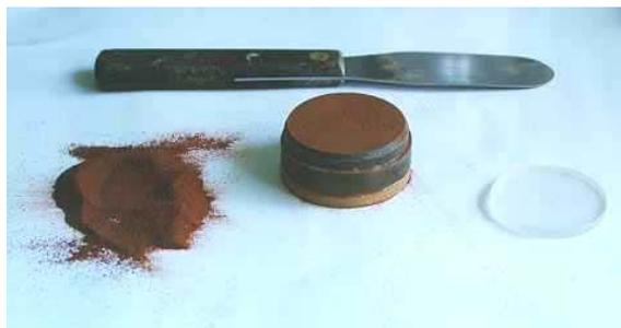
Foto 13 – Ensaio de expansibilidade LNEC – detalhe da amostra
