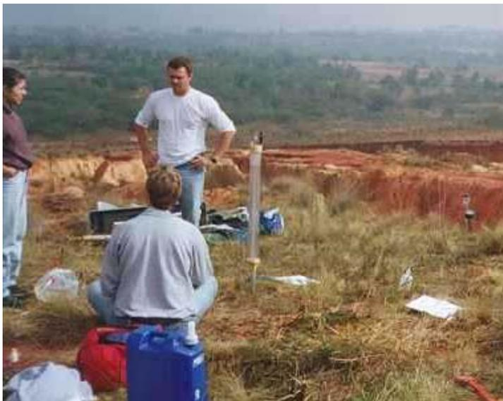
Foto 15 – Execução de ensaios de condutividade hidráulica com o permeâmetro de Guelph na cabeceira da boçoroca (ALG)
