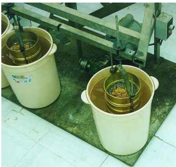
Foto 22 – Estabilidade de agregados – execução do peneiramento múltiplo submerso
