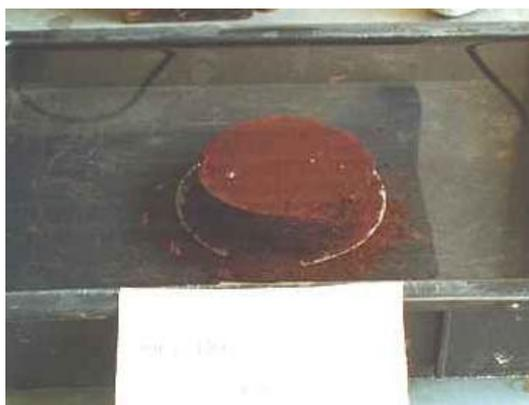
Foto 17 – Ensaio de desagregação – amostra resistente a desagregação
