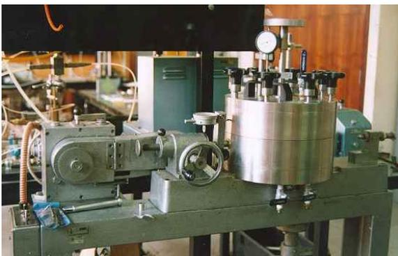
Foto 1 – CDCS – câmara de compressão adaptada ao equipamento de cisalhamento direto convencional
