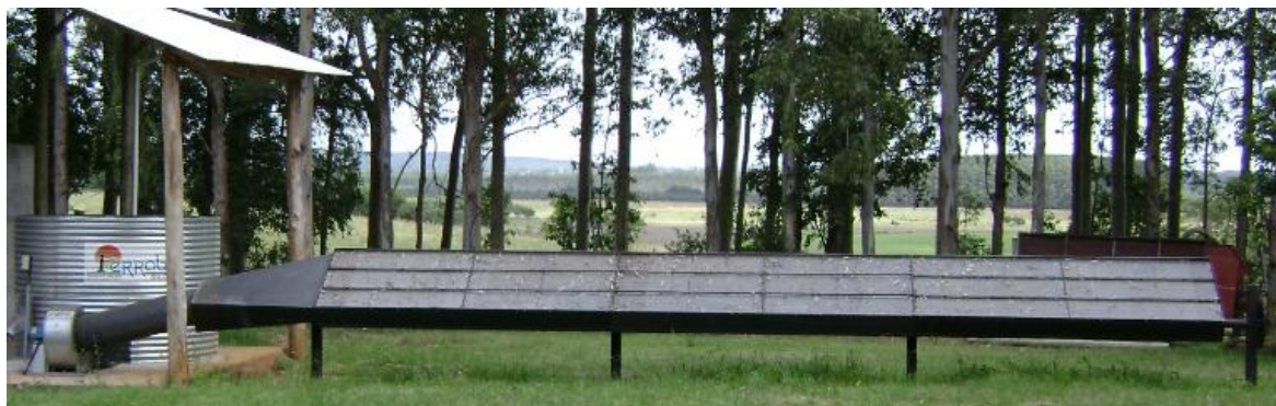
FIGURA 3. Secador solar com capacidade para 100 sacos de milho. Eldorado do Sul, RS. 2010.
