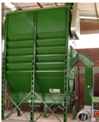
FIGURA 4. Secador intermitente utilizado para secagem do milho. Eldorado do Sul, RS. 2010.
