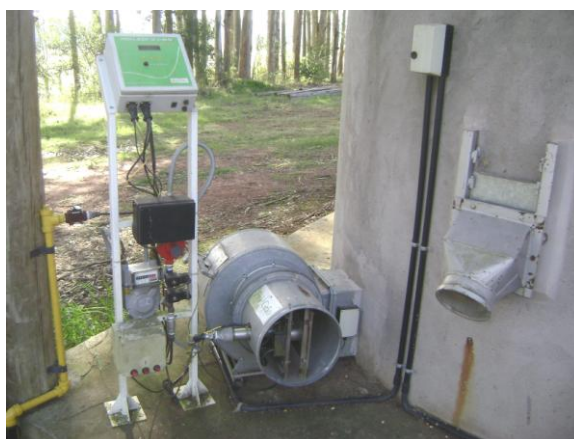
FIGURA 2. Ventilador e queimador utilizados para secagem estacionária com GLP. Eldorado do Sul, RS. 2010.
