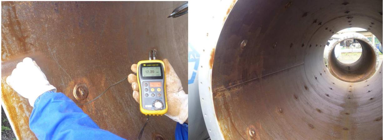
*Figura 21 – Medição de espessura em duto novo (Cortesia Gerdau Guaíra)*
