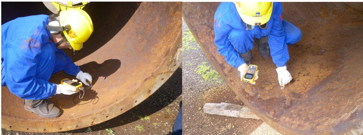
Figura 20 – Medição de espessura em duto após troca preventiva (Cortesia Gerdau Guaíra)
