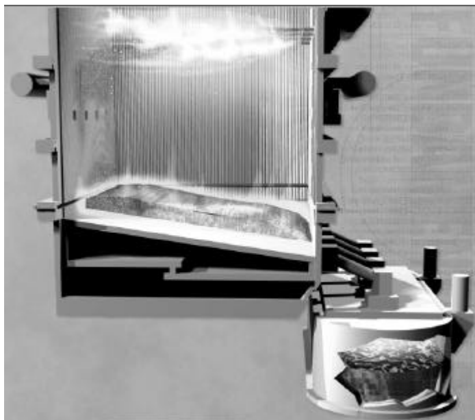
Figura 3: Caldeira de Recuperação e Tanque de Dissolução do Smelt
