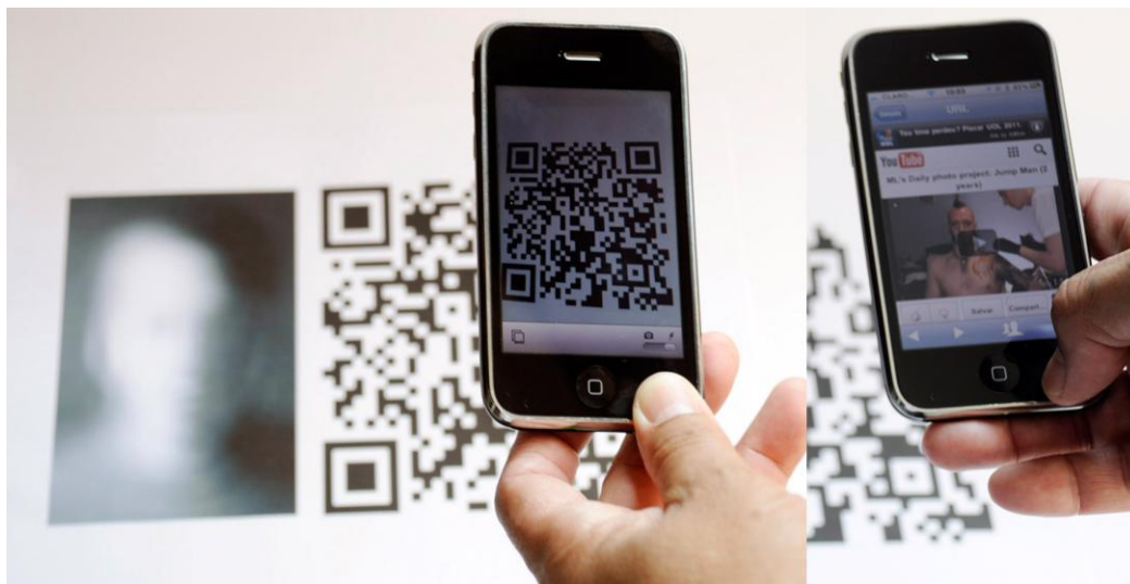
FIG.38 - Acima, exemplos do funcionamento do sistema QR-CODE após leitura dos dados usando o aplicativo QR-Reader para smartphones com câmera. Ao ler o código, e conectado à uma rede, o programa direciona a imagem direto para o foto-vídeo matriz. Fotos © Flavya Mutran
