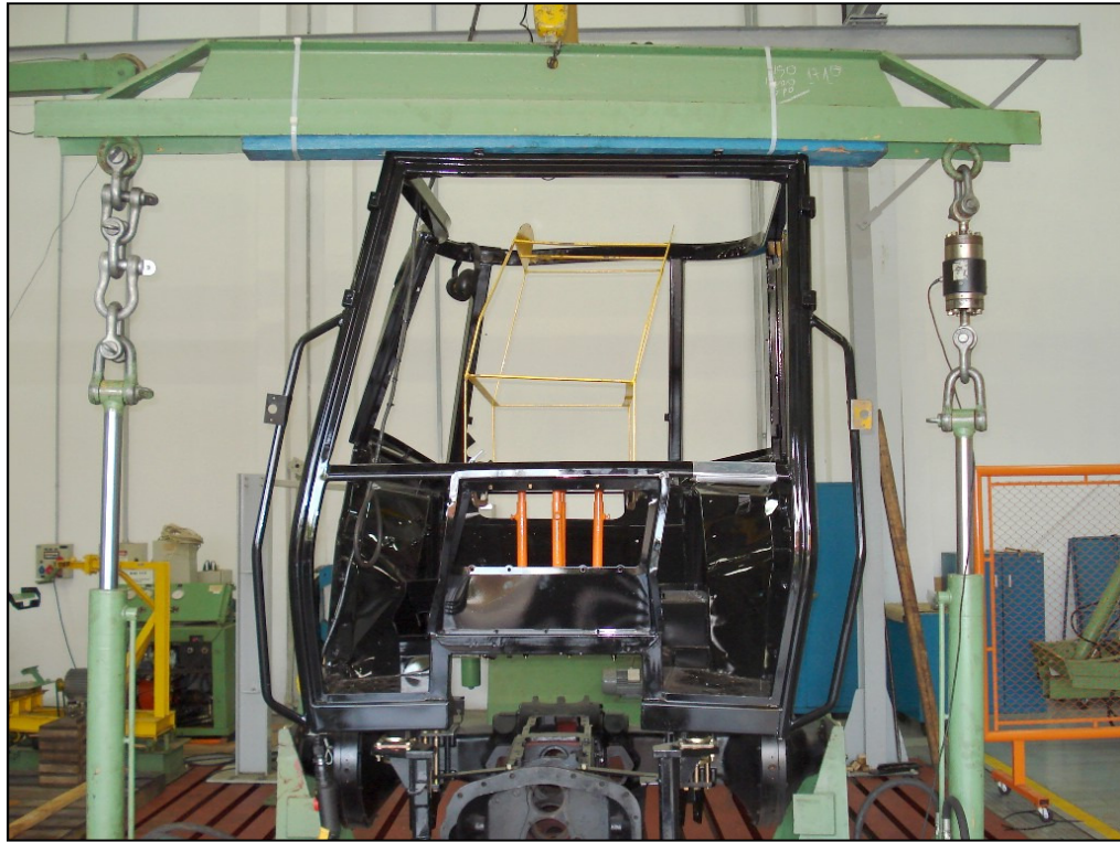
Figura 2.11 - Ensaio de esmagamento das colunas dianteiras. Fonte: Arquivo AGCO do Brasil (2008)
