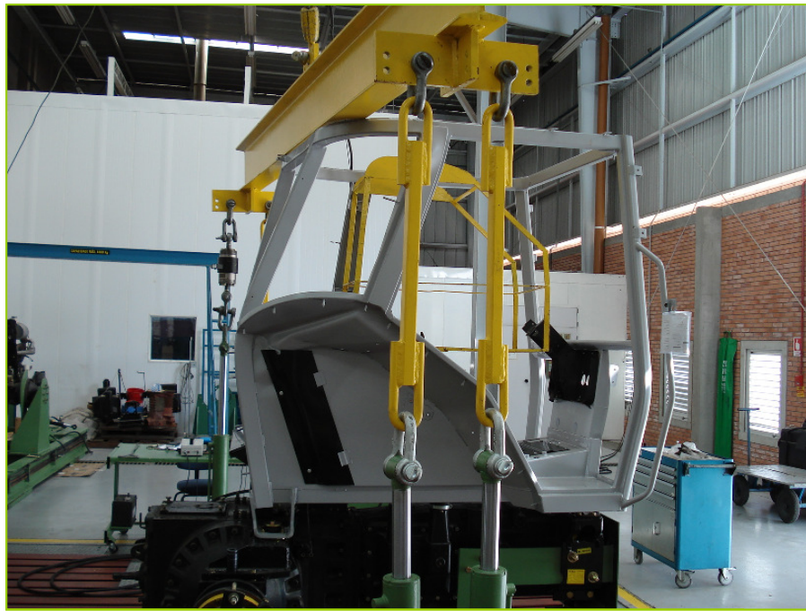
Figura 2.9.1 - Ensaio de esmagamento das colunas traseiras. Fonte: Arquivo AGCO do Brasil (2008)
