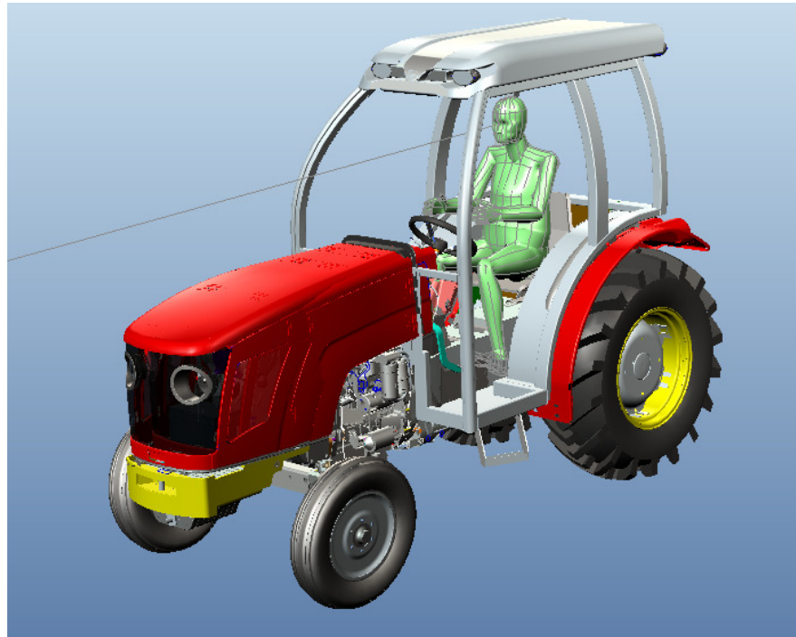
Figura 4.1 - Imagem em perspectiva do lay-out do trator estreito com a cabina e o teto já montados.
