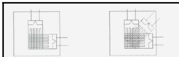
Figura H.3 - a) *Strain gage* roseta do tipo delta; b) *Strain gage* tipo roseta bi-axitri-direcional.
