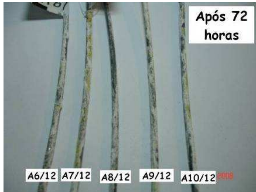
Figura 38. Teste 1 – Amostras do arame BWG 12 na posição do fio 6 e ponto de coleta A, após 72 h de ensaio em névoa salina.
