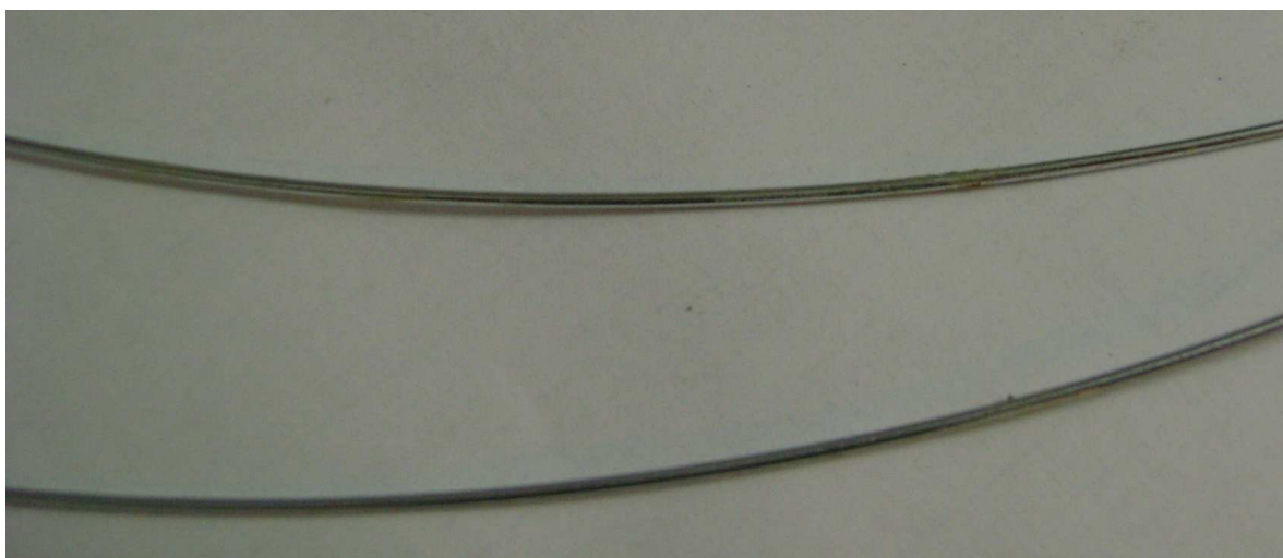
Figura 43. Amostras do arame BWG 18 – Teste 2 – cujos tempos de imersão no banho de cromatização foram superiores ou iguais a 10 s apresentando coloração amarelada.
