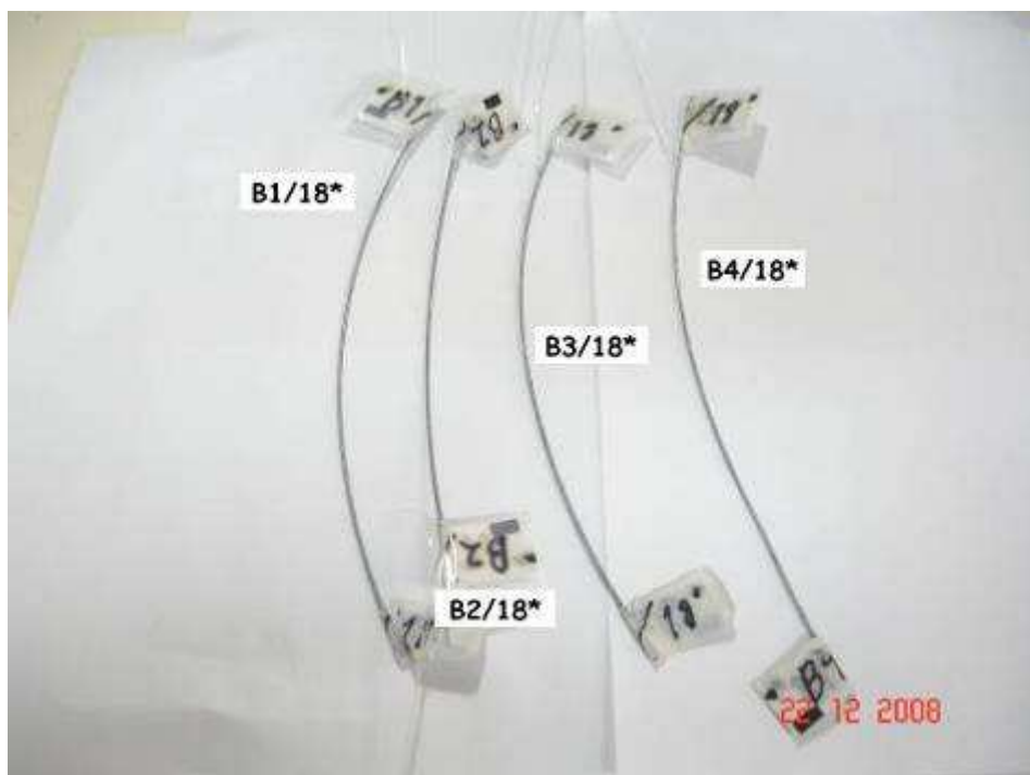
Figura 24. Teste 1 – Amostras do arame BWG 18 na posição do fio 6 e ponto de coleta B, após 624 h de ensaio em câmara úmida.
