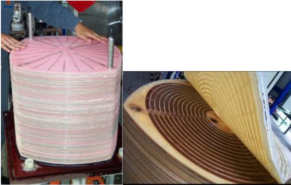
Figura 14- Montagem de um módulo de membranas (membranas catiônica, aniônica e espaçadores).
