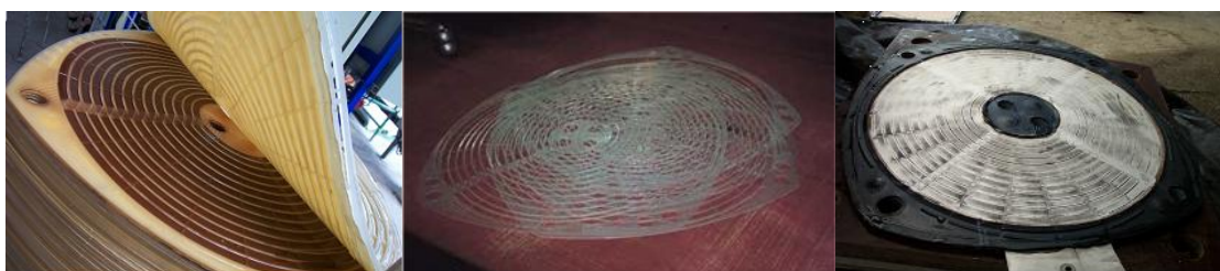
Figura 37- Foto das membranas, espaçador e eletrodo respectivamente utilizados nos testes na REGAP.
