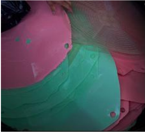
Figura 56- Foto das membranas HDX100 e HDX200 tiradas da unidade-piloto na Regap.
