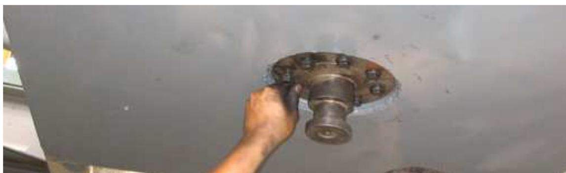
Figura 2.3: Pino sendo instalado em um caminhão. Fonte: <http://www.serv-molas.com.br/photo/showpic.php?picid=191> em 28/01/2010.
