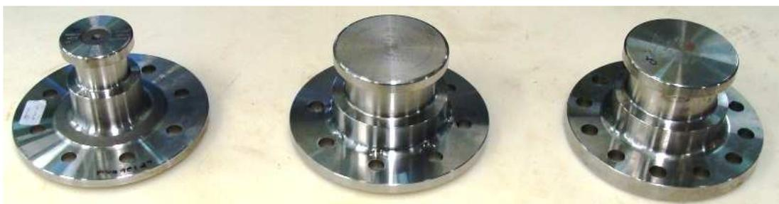
Figura 4.2: Amostras de Pinos Rei de 2” e 3,5” com oito e doze furos para fixação.
