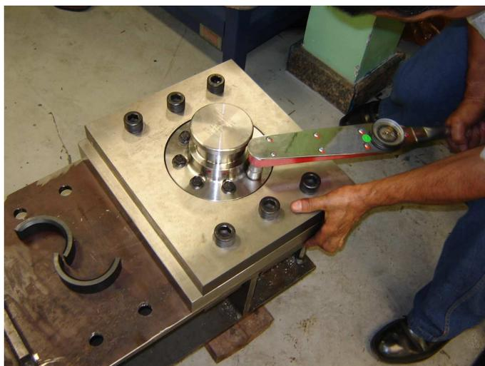
Figura 4.3: Amostras de pinos rei sendo fixada ao dispositivo de ensaio.
