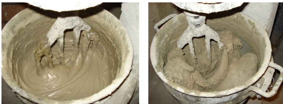
Figura 6.1: PPECC 1 produzido com cimento tipo V: (a) antes e (b) após a adição das fibras.
