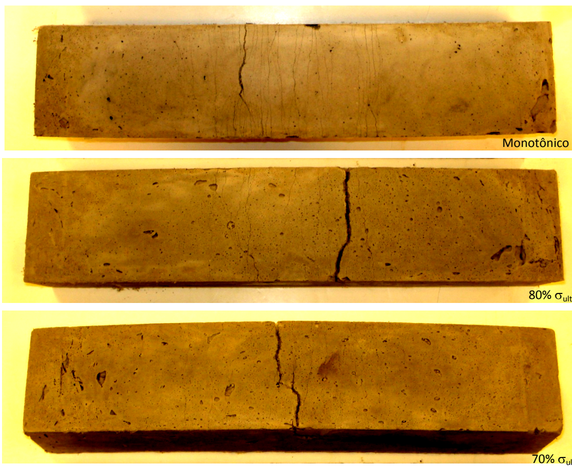
Figura 6.15: Número de fissuras desenvolvidas nos corpos-de-prova em função do nível de tensão aplicado
