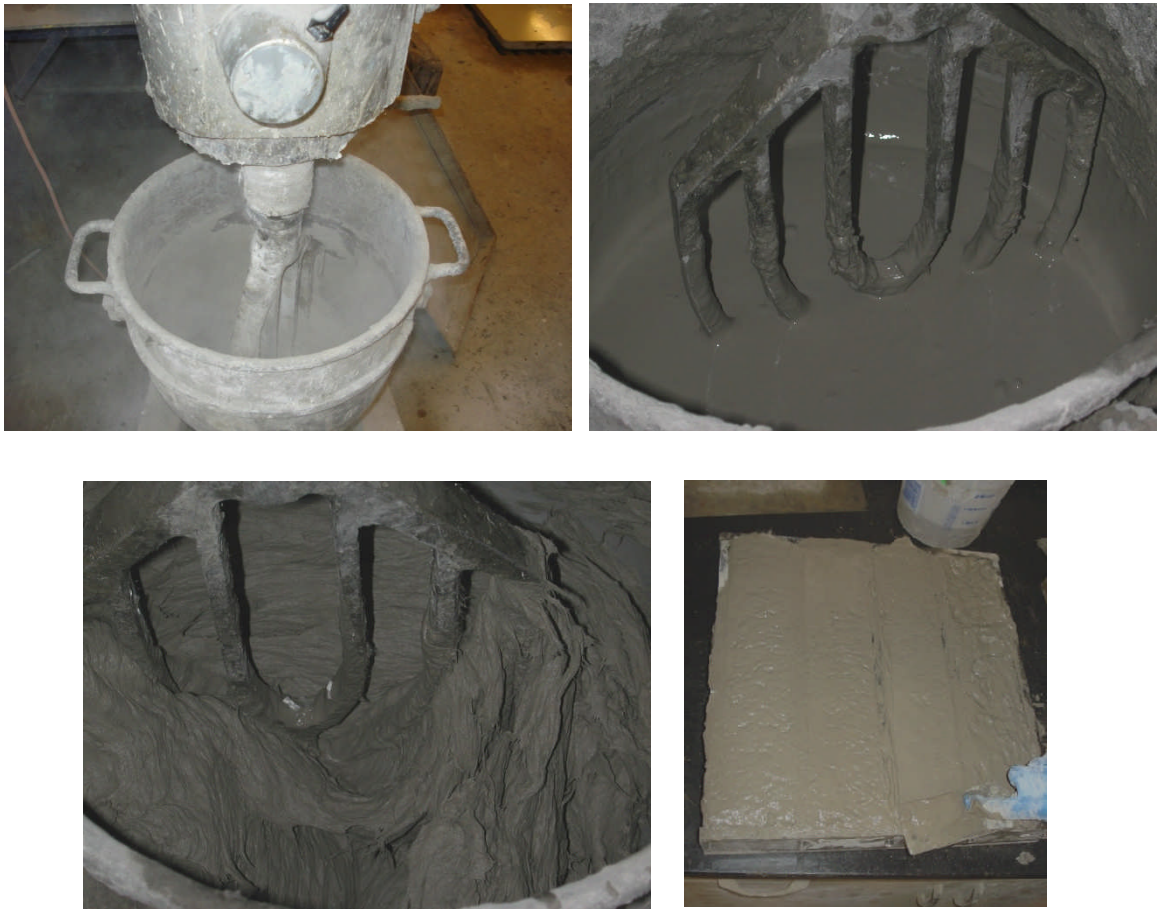
Figura 4.3: Processo de mistura e moldagem: (a) mistura dos materiais secos, (b) aspecto da mistura após a adição da água de amassamento e aditivo, (c) mistura após a adição das fibras e (d) processo de moldagem e finalização de corpos-de-prova prismáticos.
