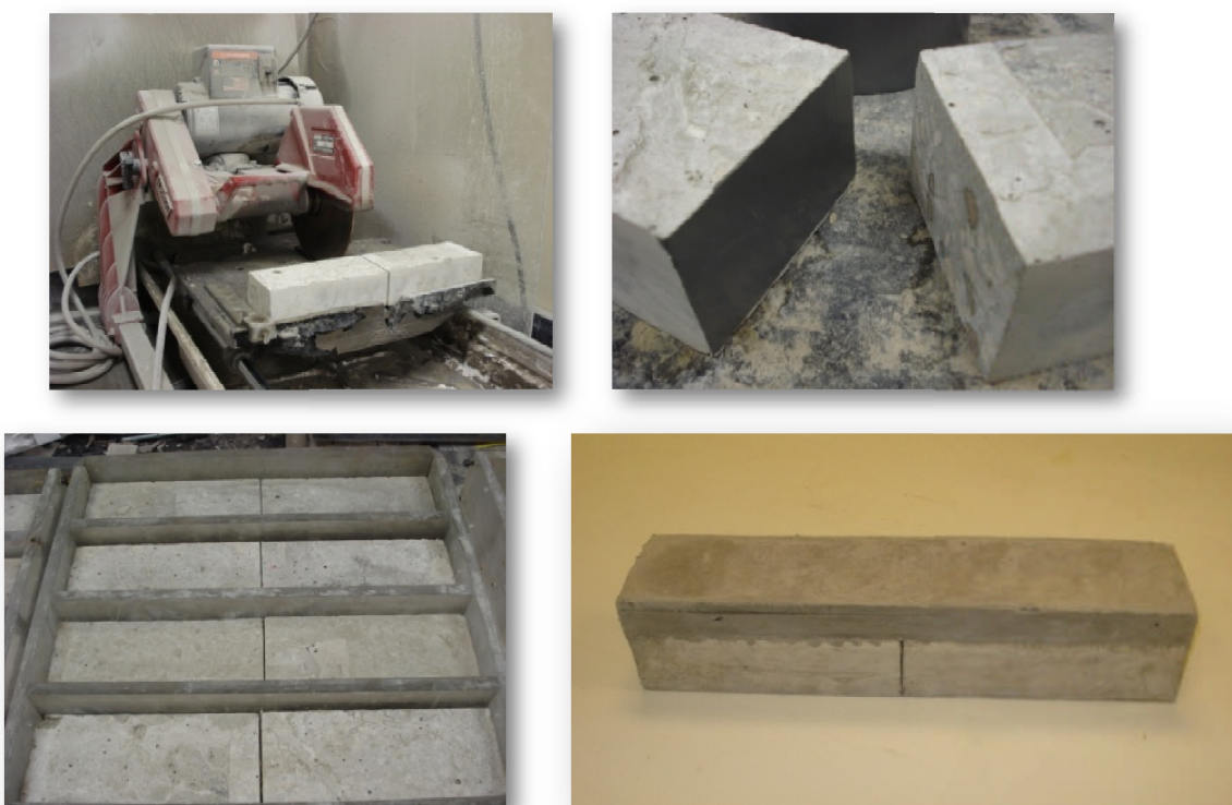
Figura 4.7: Processo de produção dos corpos de prova: (a) corte das bases, (b) colagem de fita no corte central (c) bases preparadas para receber a camada de overlay e (d) corpo-de-prova após desmoldagem.
