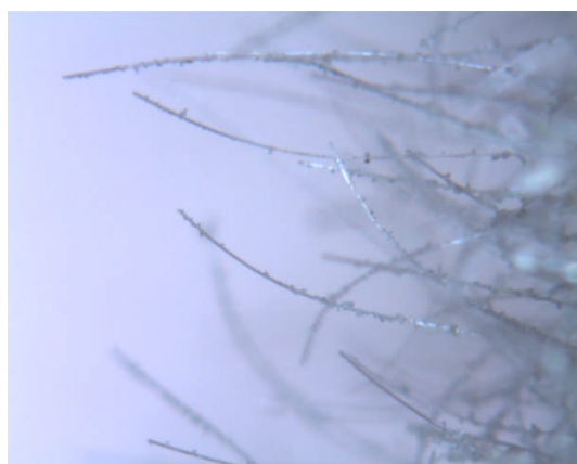
Figura 6.10: Seção de ruptura da viga produzida com compósito PPECC 5 submetida à fadiga com \sigma_{\text{máx}}/\sigma_{\text{ult}} igual a 0,6.
