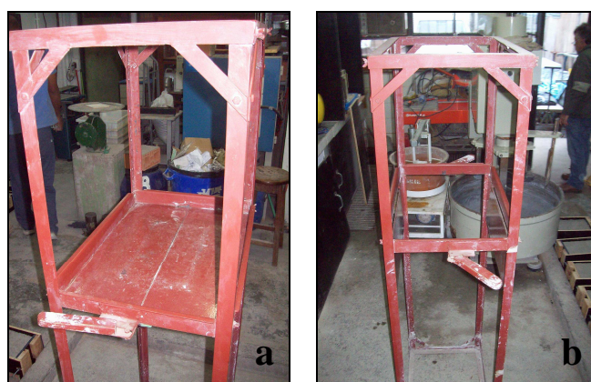
Figura 10: vista geral da base móvel da caixa de queda (a) antes e (b) depois do acionamento das alavancas
