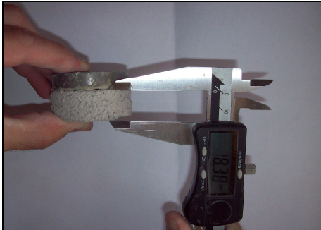
Figura 23: medida da espessura com paquímetro
