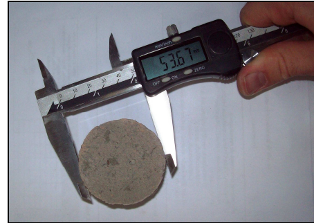
Figura 24: medida do diâmetro com paquímetro
