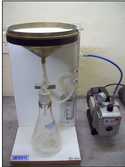
Figura 26: funil de Buchner utilizado no ensaio de retenção de água
