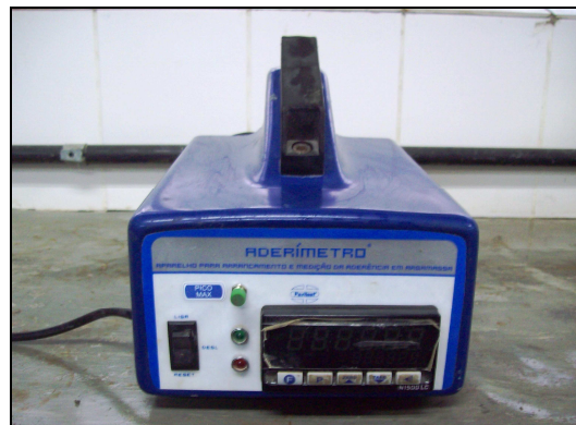
Figura 22: aderímetro digital utilizado
