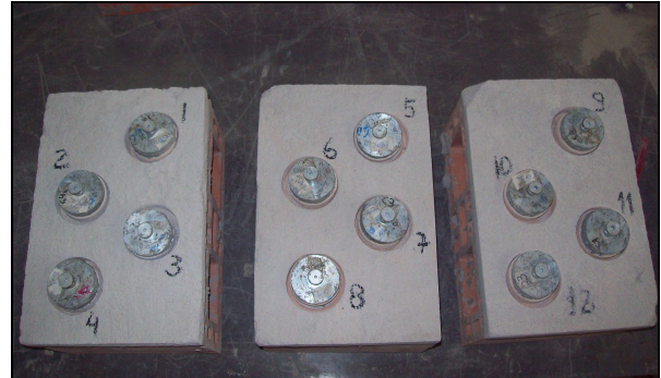
Figura 20: prismas prontos para o ensaio de aderência
