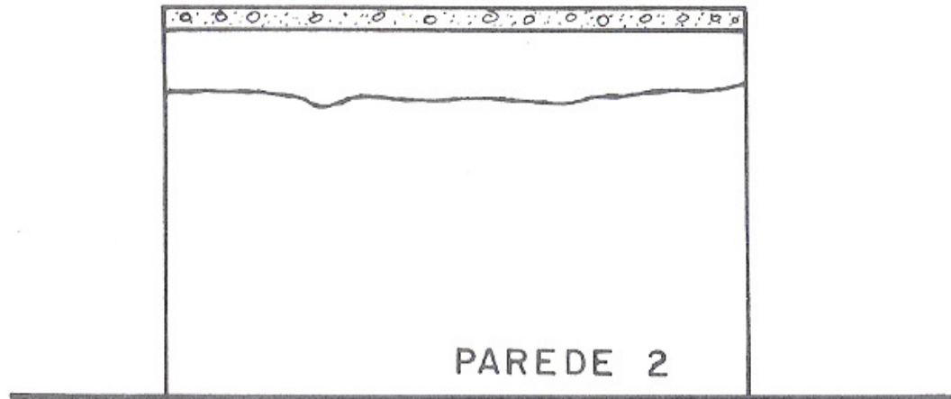
Figura 5 – fissura típica na parede junto à largura da laje devido a variações de temperatura (THOMAZ, 1989, p. 24)
