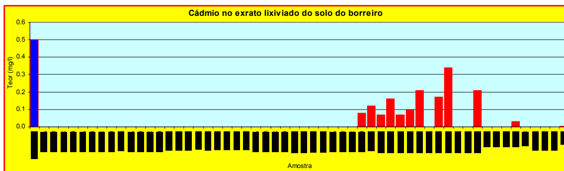
Figura 6.18. Teores de cádmio no extrato do lixiviado das amostras de sedimentos do Borreiro em comparação com o valor máximo de resíduos não tóxicos (coluna azul), destacando-se a ausência de amostras representativas de resíduos tóxicos Classe I.
