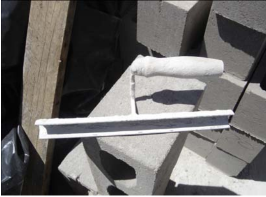
Figura 9: canaleta para assentamento de bloco
