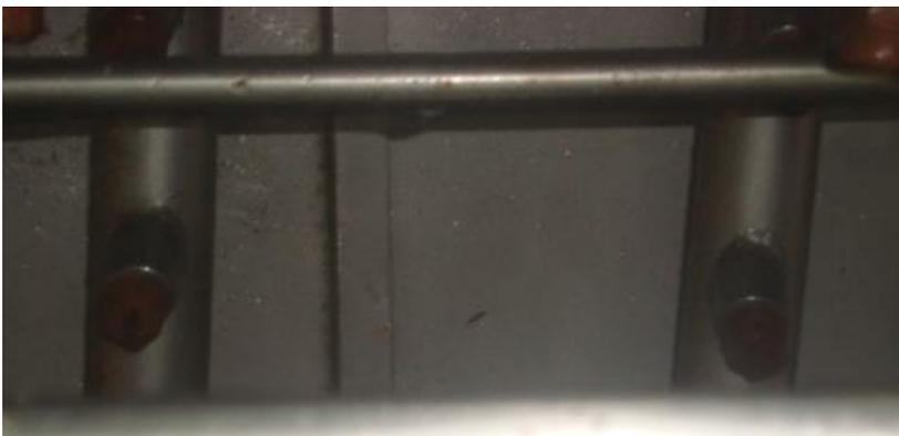
**Figura 9: Foto dos bicos aspersores de água da máquina de higienização de gaiolas.**
