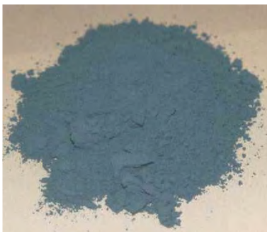
Figura 5.8 Escória granulada de fundição moída em moinho de bolas (tempo de moagem = 40 minutos), utilizada na realização do projeto experimental
