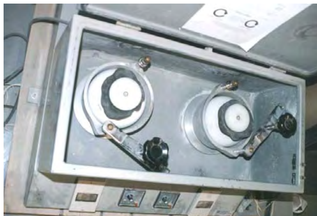
Figura 5.7 Vista superior do moinho de bolas utilizado para moagem da escória granulada de fundição (EGF)
