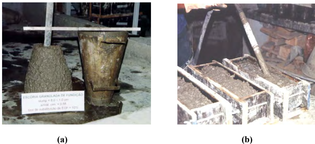
Figura 5.16 a) medição da consistência do concreto através do ensaio de abatimento do tronco de cone b) adensamento dos corpos-de-prova de concreto, utilizando-se vibrador de imersão
