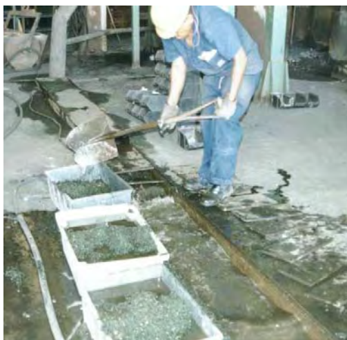
Figura 5.5 Coleta da amostra de escória granulada de fundição (EGF), após resfriamento brusco, no canal de fluxo d'água contínuo
