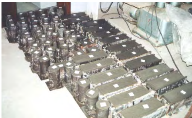
Figura 5.17 Corpos-de-prova produzidos durante a execução de 6 diferentes traços de concreto (6 concretagens)
