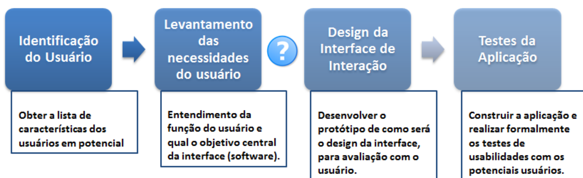
Figura 2 – Processo de desenvolvimento de interfaces user-based por Wood [3]
