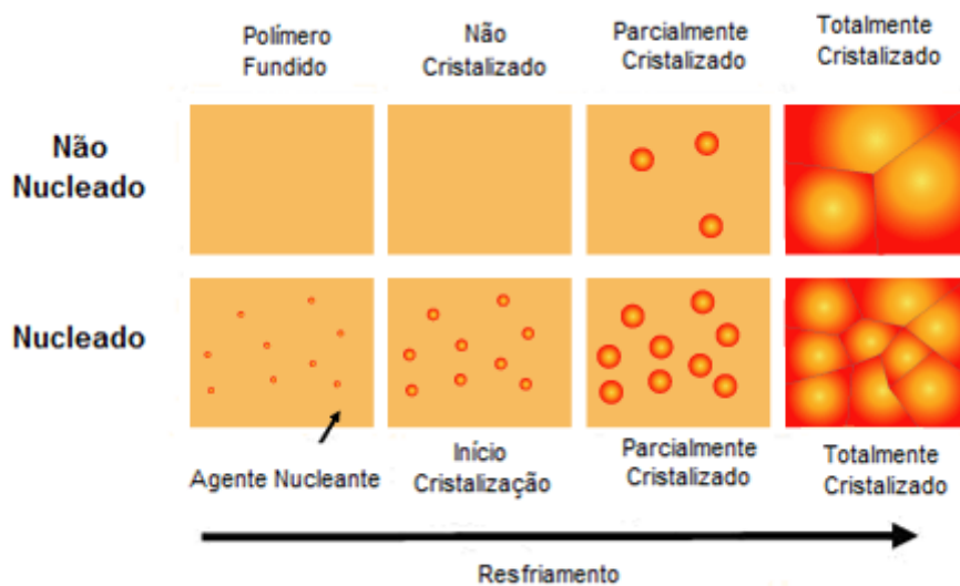
Figura 7. Representação do processo de cristalização de uma matriz polimérica na ausência e na presença de agente nucleante [59]
