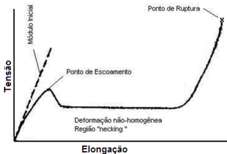
Figura 12. Representação esquemática de uma curva tensão/elongação para polímeros semicristalinos [11] .
