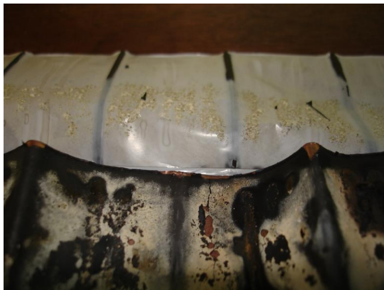
Figura 45. Sal de lítio cristalizado na interface ânodo-separador encontrado durante o processo de abertura das baterias.
