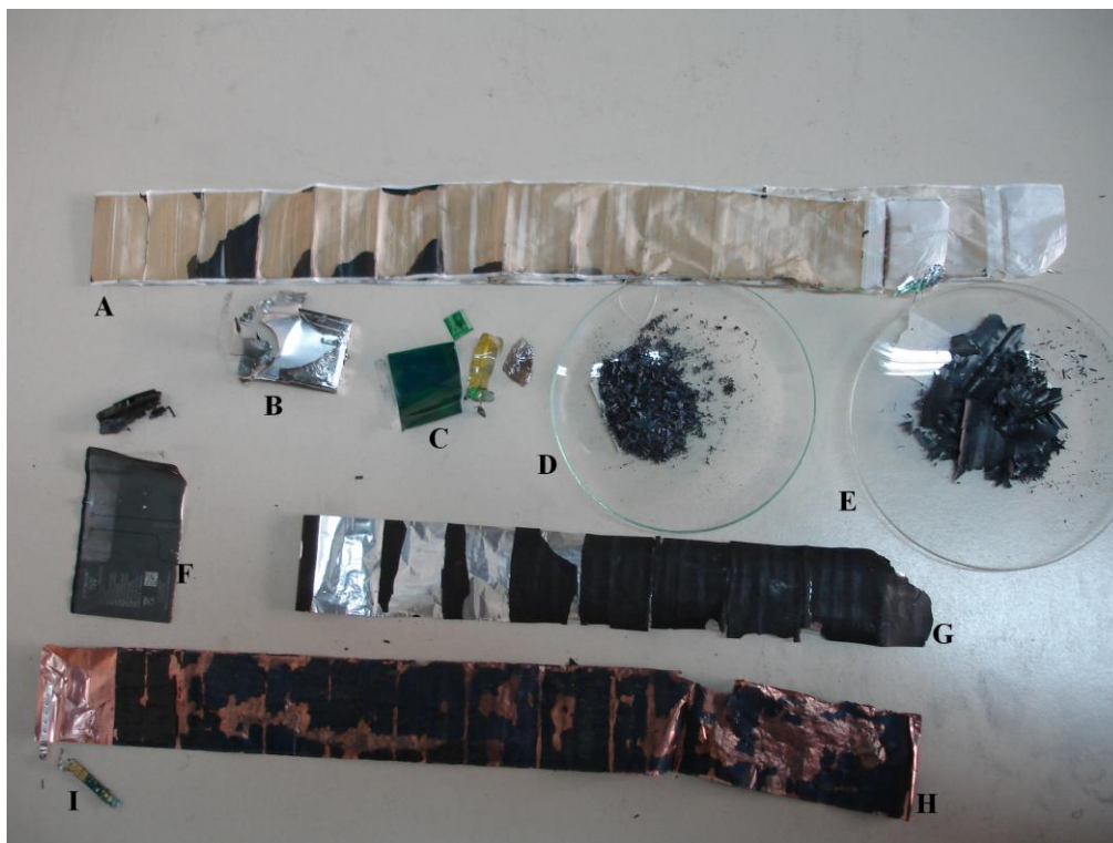
Figura 18. Componentes de uma bateria de íons de lítio: A- Separador; B – Blindagem metálica; C- Fitas adesivas; D – Material ativo do cátodo; E – Material ativo do ânodo; F- Carcaça externa; G – Coletor de carga do cátodo; H – Coletor de carga do ânodo; I – PCI's.
