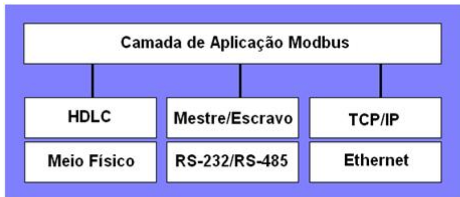
Figura 3.1: Esquemático com tipos de protocolos Modbus citados em relação a camada de aplicação Modbus
