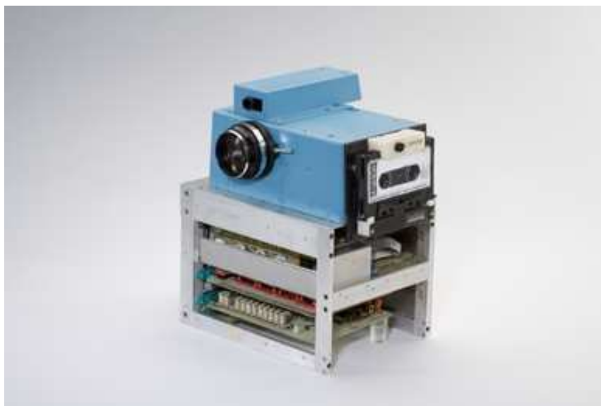
Fig. 28 – A primeira câmera considerada digital, da Eastman Kodak Company, 1975. Feita da união de dispositivos analógicos e digitais a uma lente de câmera Super 8.
