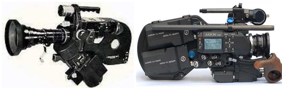
Fig. 25 – À esquerda a NPR Éclair, câmera de 1963 que, depois de modificada, se tornou a primeira câmera a rodar um longa-metragem em Super 16 e à direita a Aaton Xterà, um dos mais novos lançamentos neste formato.
