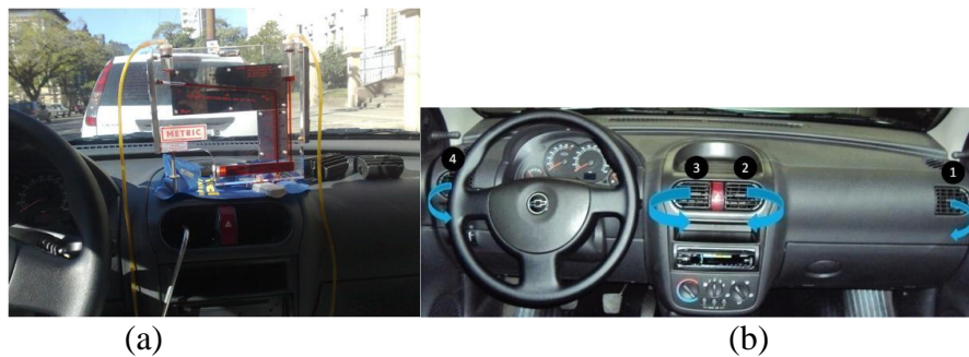
Figura 4.11- Medição da velocidade nos quatro difusores com tubo de pitot
