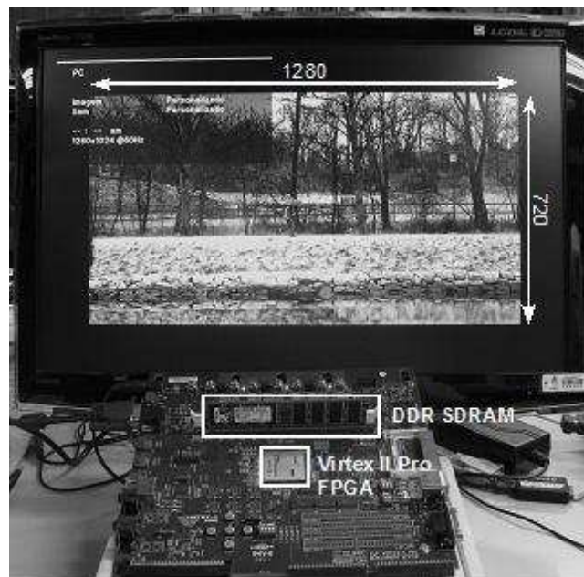
Figura 3.2: Vídeo Parkrun HD 720p sendo decodificado em FPGA (BONATTO, 2010).
