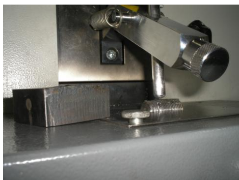
Figura 4.6 – Realização do ensaio de análise química em amostra do parafuso
