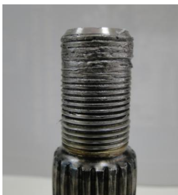
Figura 2.1 – Perfil do parafuso M20x1,5 com a rosca espanada
