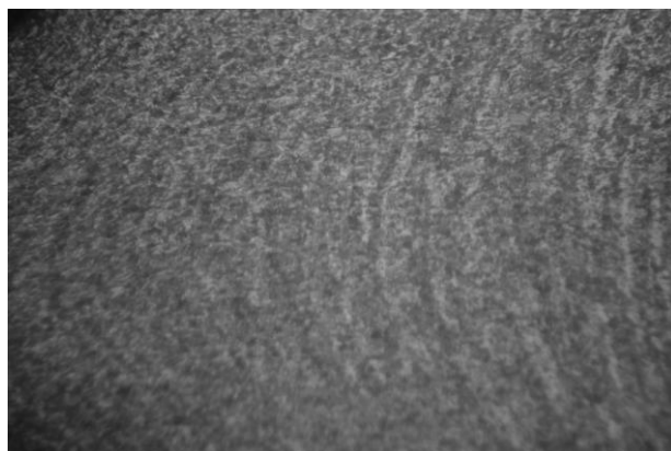
Figura 5.4 – Detalhe da deformação das fibras do material do parafuso produzidos por rolamento
