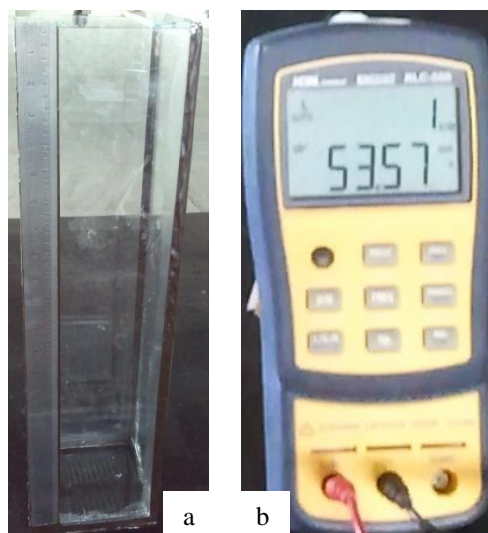
Figura 2.5 – (a) Cuba de vidro para realização dos testes. (b) Medidor de capacitância utilizado na bancada de testes.
