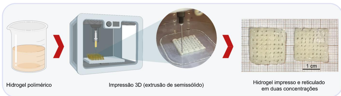
Figura 4. Representação esquemática das etapas de obtenção do hidrogel 3D
