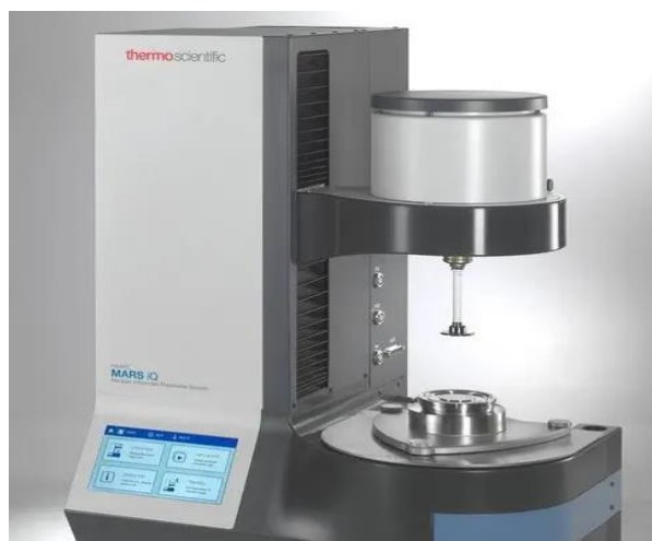
Figura 2 – Reômetro rotacional Haake MARS – Fonte: Thermo Fisher Scientific, 2024.
