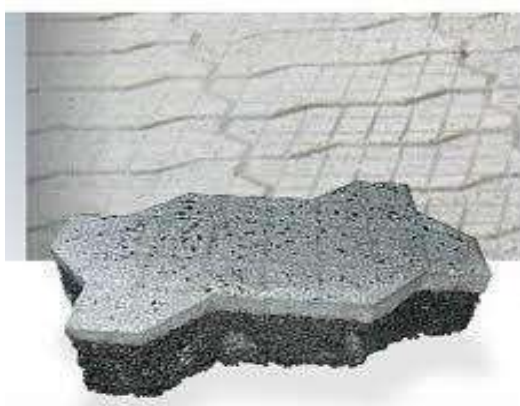
Figura 12: Blocos de concreto com raspas de pneu
