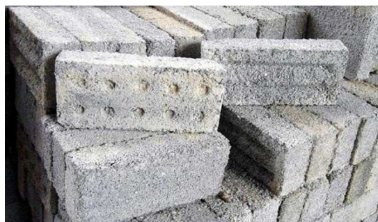
Figura 14: Tijolo sustentável feito a partir de garrafas descartáveis (PET)
