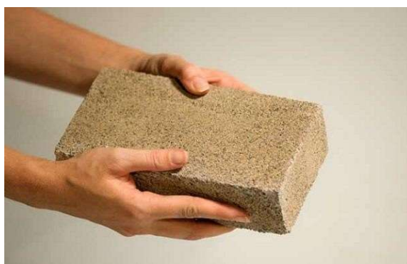
Figura 13: Tijolo ecológico feito a partir de bactérias
