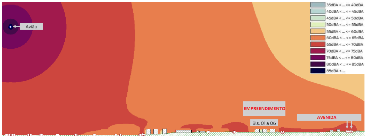
Figura 13 - Corte C1 mostrando os níveis de pressão sonora na região
