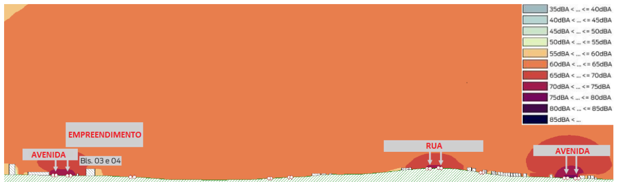
Figura 14 - Corte C2 mostrando os níveis de pressão sonora na região
