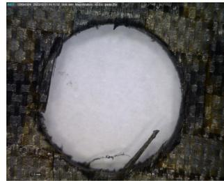
(d) Furo 12 ( $V_c = 50$  m/min)**Figura 6** - Saída dos furos feitos com broca helicoidal
