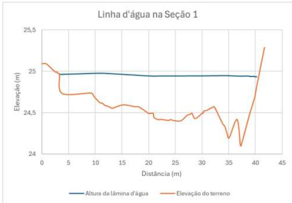
Figura 38- Linha d'água na seção 1 do rio Maquiné simulada no cenário de vazão constante medida em campo
