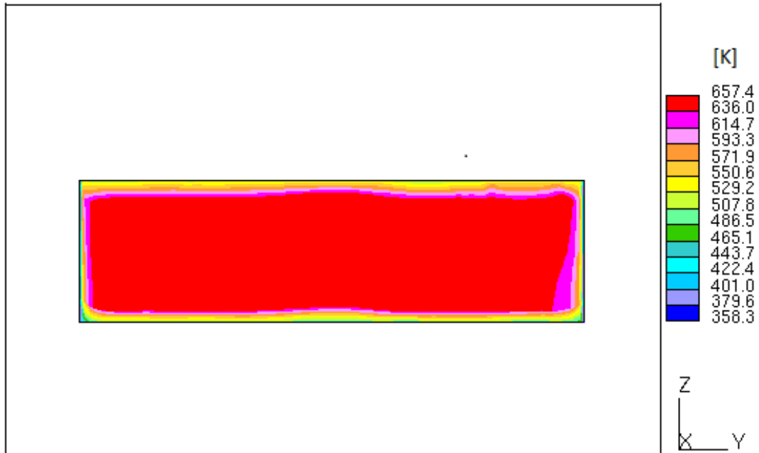
Figura 7.23 – Temperatura no interior do cilindro na máxima compressão (plano Y-Z)
