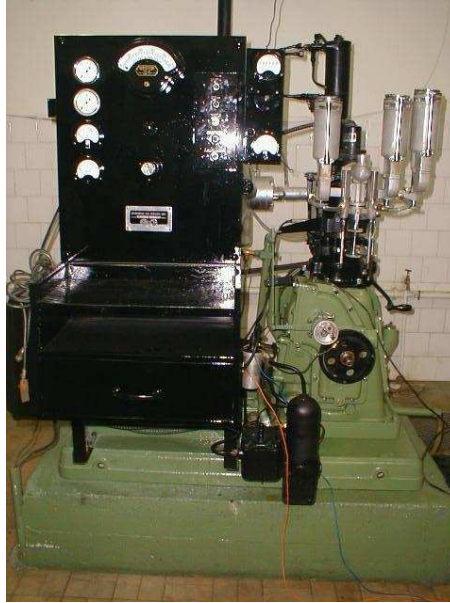
Figura 7.5 - CRF do Laboratório de Motores do Departamento de Engenharia Mecânica da UFRGS.
