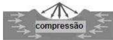
Figura 2.16 - Deformação local causada pela esfera do shot peening [Metal Improvement Company Inc 2001].
