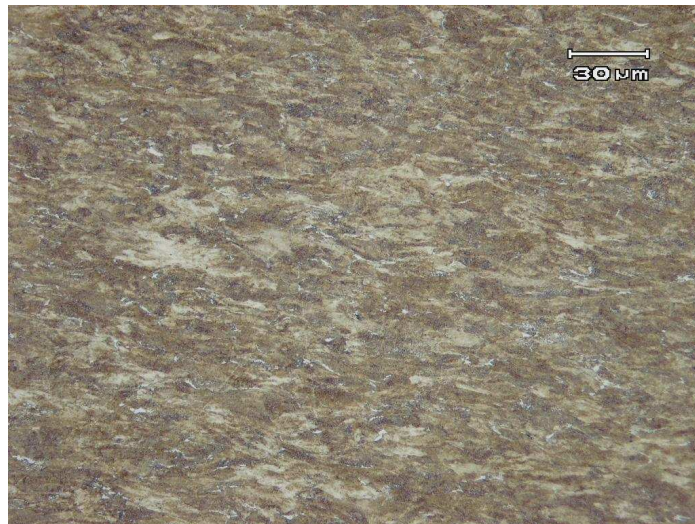
Figura 4. 1 - Microestrutura – aumento 500x – reagente nital 2%.
