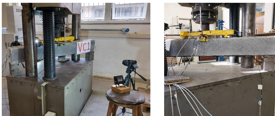
Figura 2 - Layout de captura das imagens para o ensaio de flexão a quatro pontos
