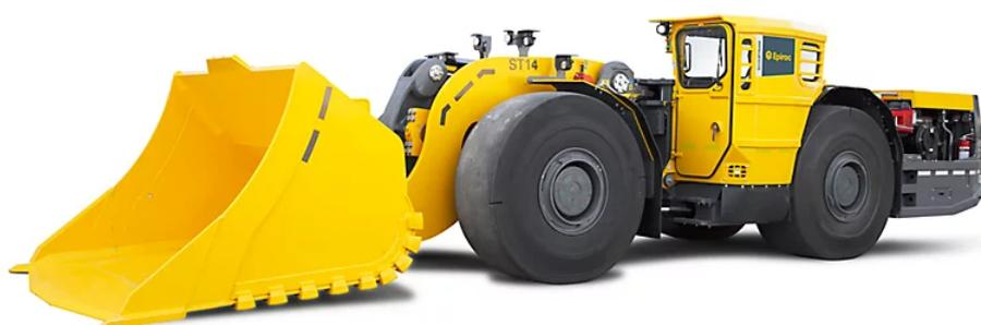
Figura 11 – Epiroc ST14 - carregadeira do tipo LHD com capacidade de carga útil de 14t (EPIROC, 2021)
