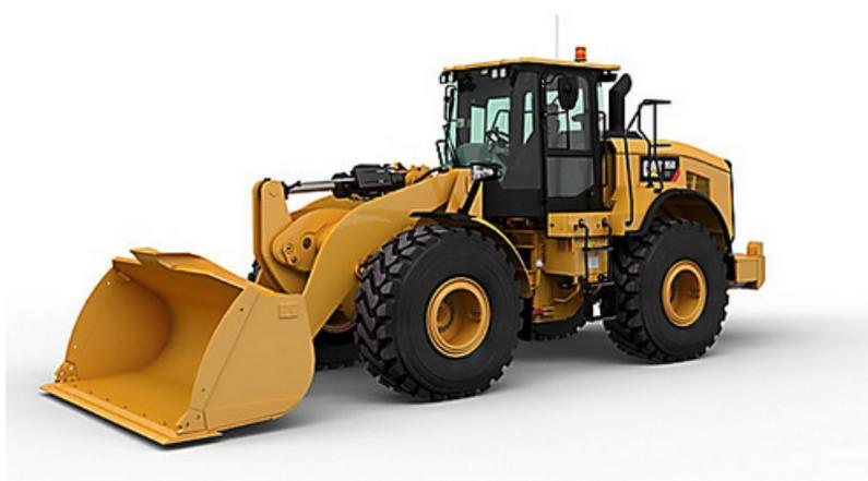
Figura 12 – Caterpillar 950CG - pá carregadeira com capacidade da caçamba de 2,5 a 4,4m<sup>3</sup> (CATERPILLAR, 2021)
