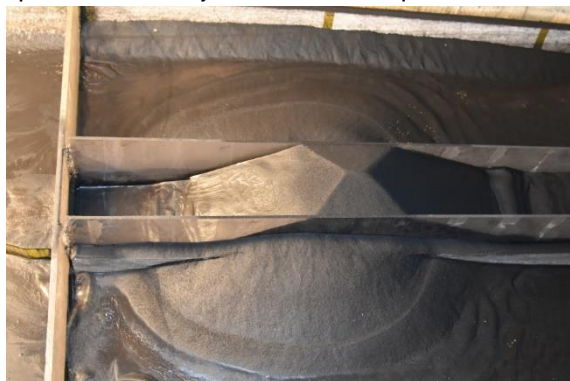
Figura 20 – Acúmulo de depósito formado junto ao difusor quando utilizado carvão do tipo 205 e 210
