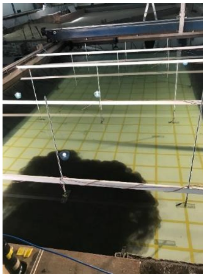
Figura 22 – Estruturação dos transdutores de UVP utilizados nas etapas 3, 4 e 5
