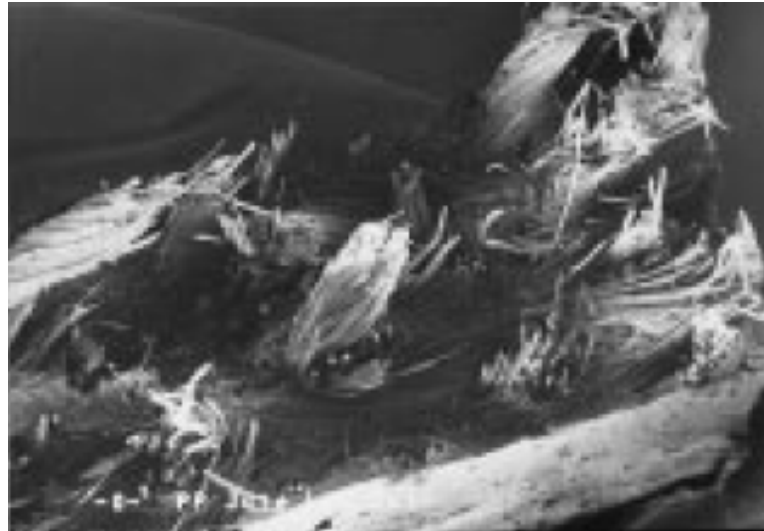
Figura 24. Micrografia obtida por MEV da superfície de fratura de compósito de PP/juta[44]
