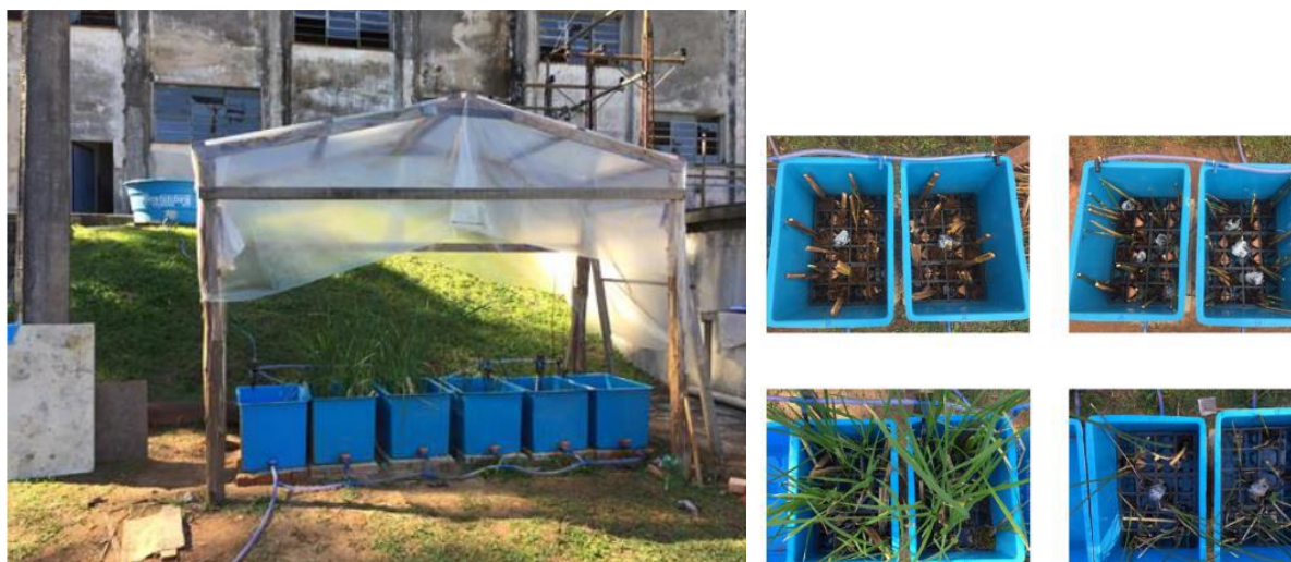
Figura 2 - Configuração do sistema flutuante de wetland construído em mesocosmos
