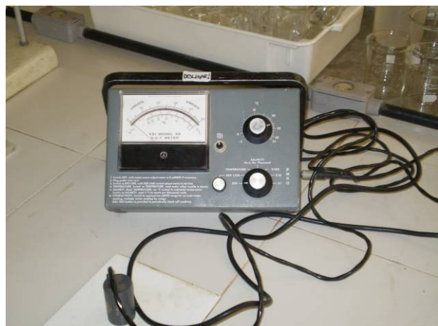
Figura 4.10: Condutivímetro do IPH
