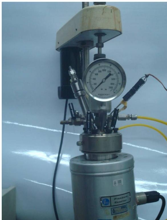
Figura 5. Reator Parr utilizado nas reações de polimerização.
